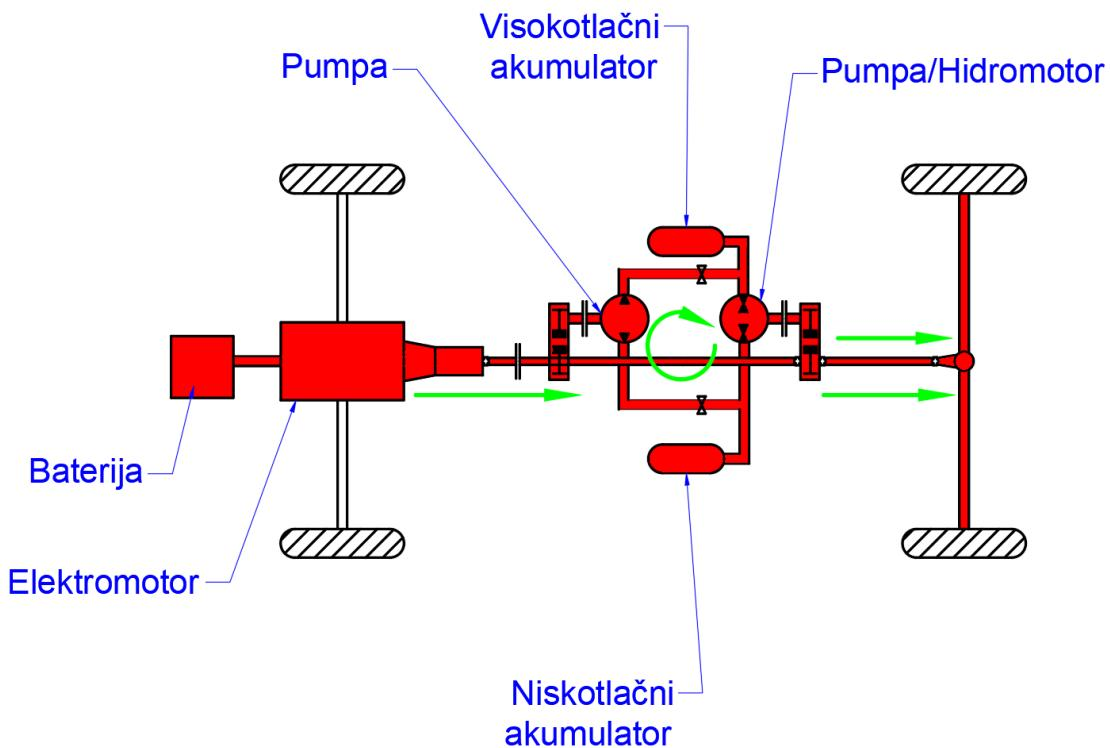
Slika 4.8 – Shematski prikaz rada vozila u načinu dvostrukog ubrzavanja
