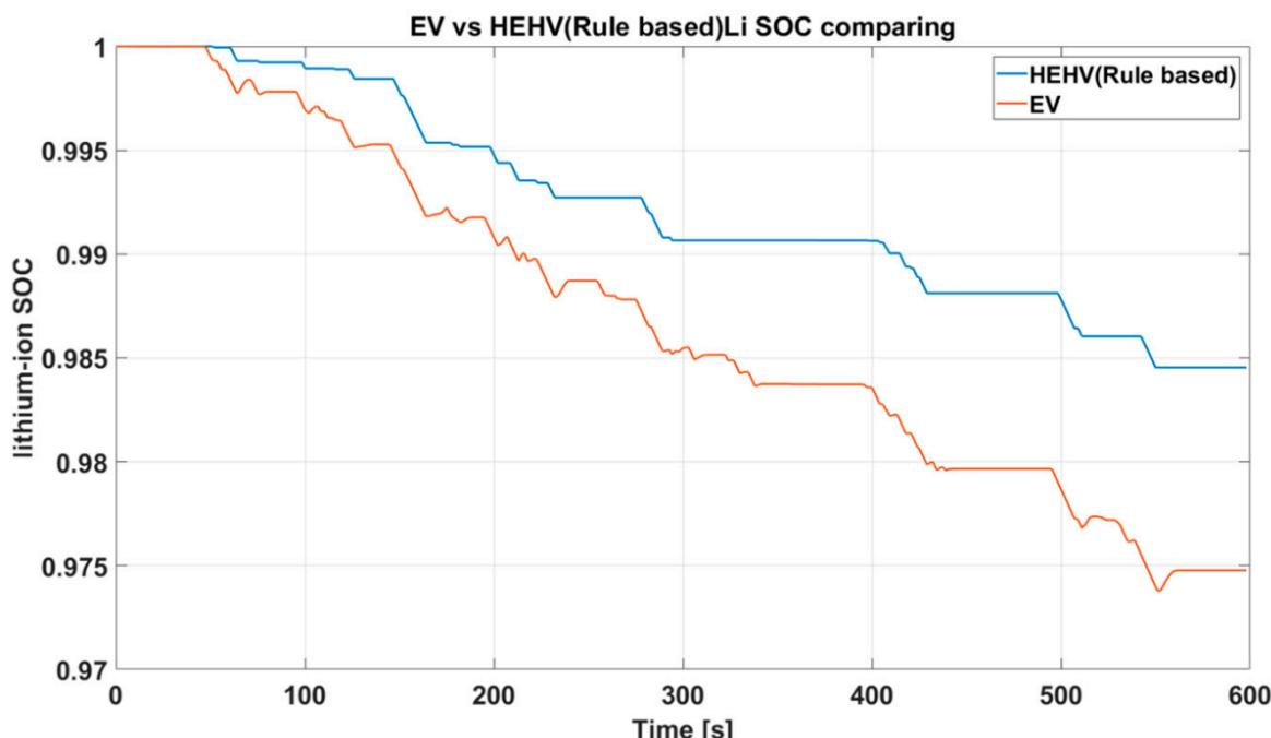
Slika 4.2 – Odnos napunjenoosti baterije kod električnog vozila i hidrauličkog električnog hibridnog vozila [16]
