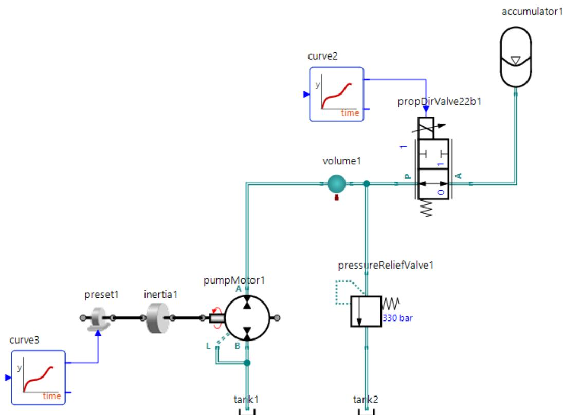
Slika 6.8 – Simulacijski model regenerativnog kočenja
