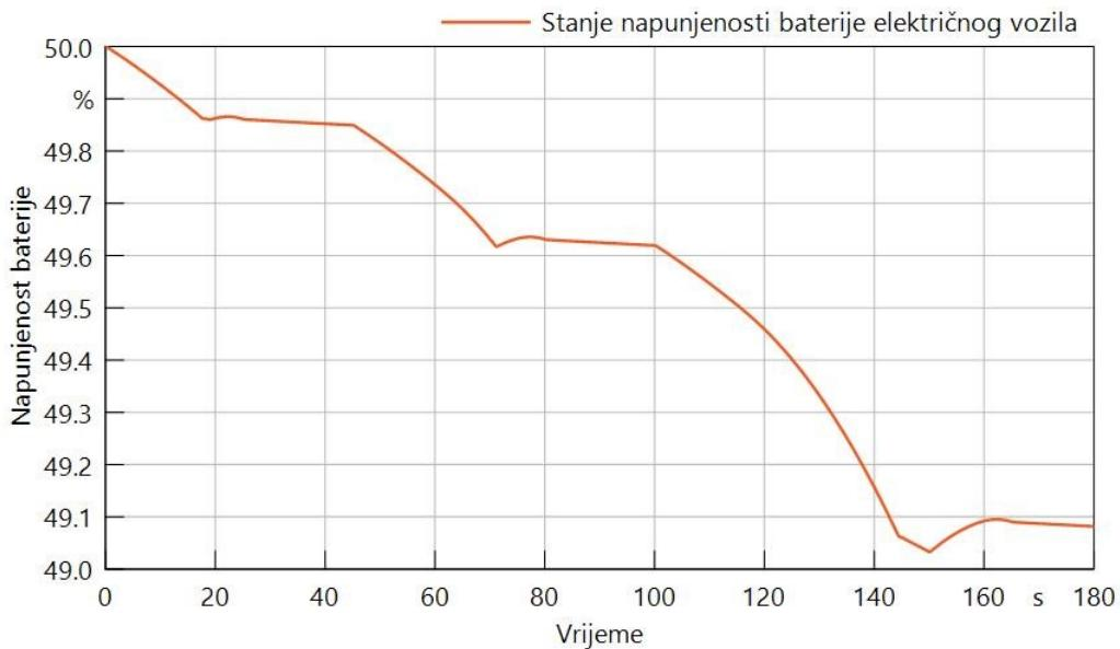
Slika 7.12 - Graf ovisnosti napunjenoštiti baterije cijelog modela električnog vozila tijekom regenerativnog kočenja o vremenu simulacije
