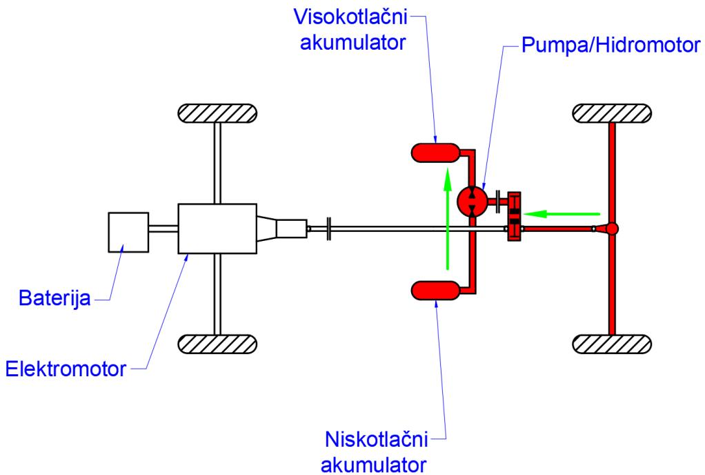
Slika 4.5 – Shematski prikaz rada vozila kod regenerativnog kočenja
