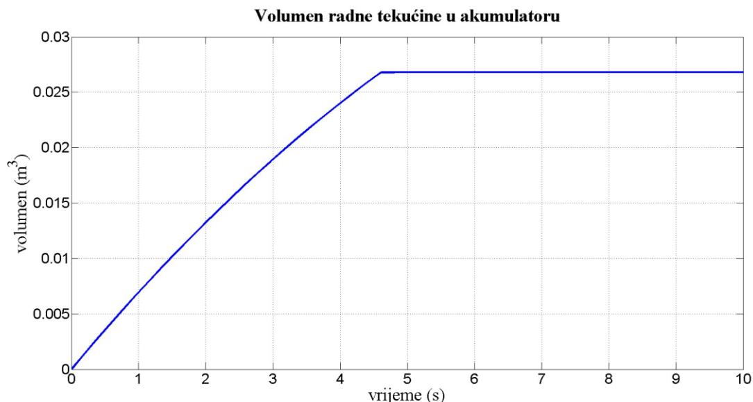
Slika 7.3 - Volumen ulja u akumulatoru tijekom regenerativnog kočenja (prethodni rad) [4]
