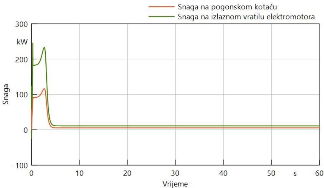
Slika 6.6 – Graf ovisnosti izlazne snage elektromotora i snage na pogonskom kotaču o vremenu simulacije za vožnju pomoći elektromotora
