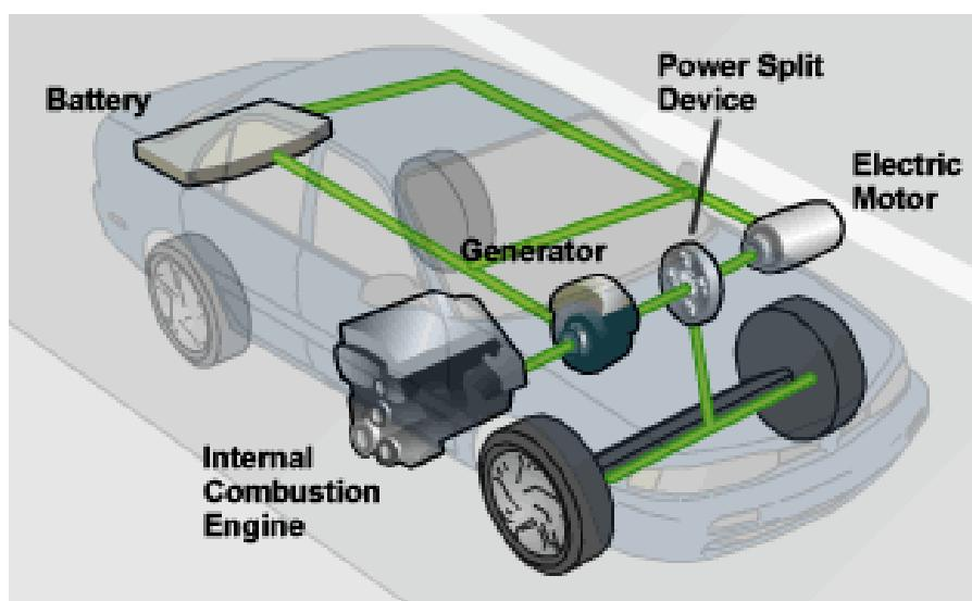
Slika 1.1 - Hibridno vozilo s elektromotorom i motorom s unutarnjim izgaranjem [2]
