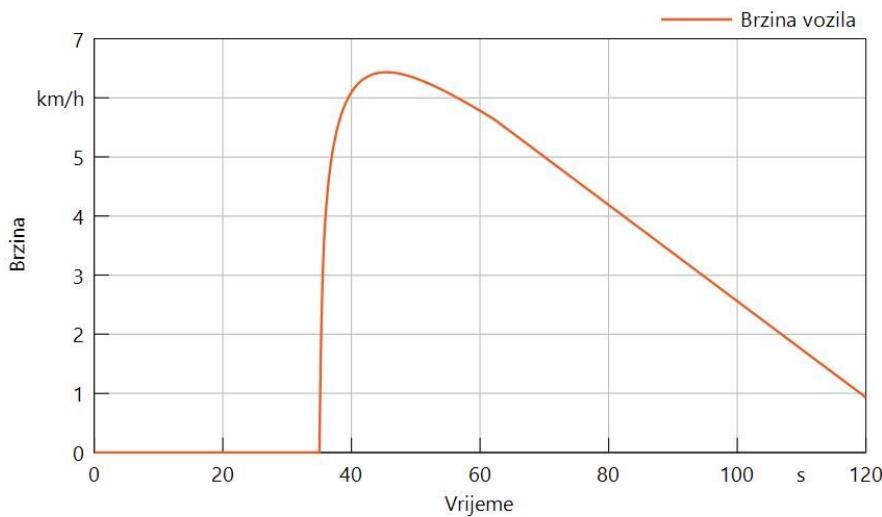
Slika 6.18 – Graf ovisnosti brzine vozila za slučaj laganog ubrzavanja o vremenu simulacije
