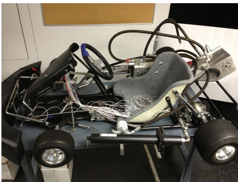
Slika 4.1 – Testno go-kart hidrauličko električno hibridno vozilo [15]
