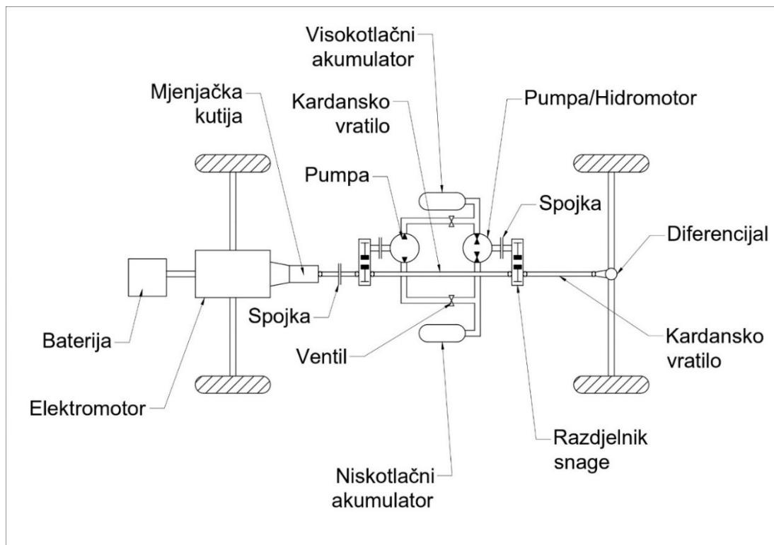
Slika 5.5 – Skica paralelnog hidrauličkog električnog hibridnog vozila
