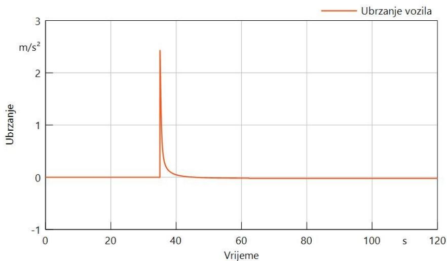
Slika 6.19 – Graf ovisnosti ubrzanja vozila za slučaj laganog ubrzavanja o vremenu simulacije
