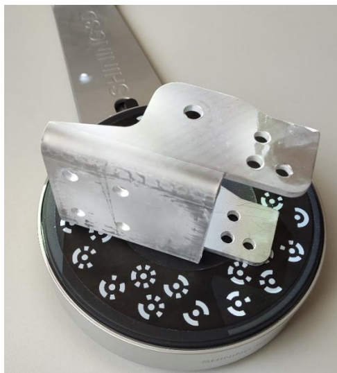
Slika 5.3. Prikaz elementa 1 s tankim slojem bijelog praha
