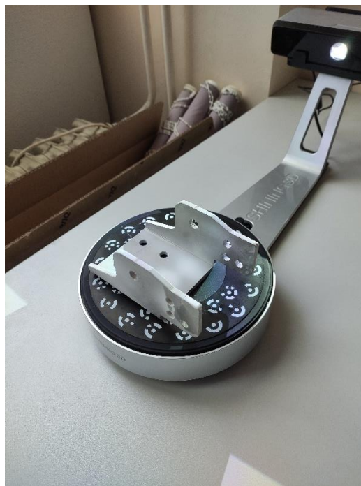
Slika 5.15. Drugi položaj skeniranja elementa 1
