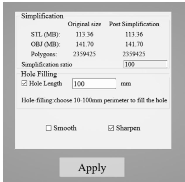
Slika 5.24. Parametri popunjavanja rupa i izoštravanja elementa 2
