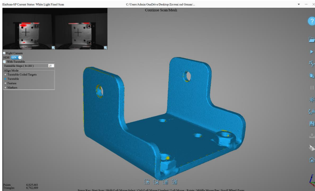
Slika 5.23. Završeno skeniranje i nezakrpani 3D sken elementa 2
