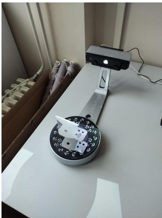
Slika 5.16. Treći položaj skeniranja elementa 1
