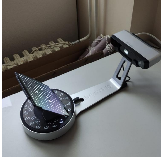
Slika 5.5. Stalak i ploča za kalibraciju postavljeni na okretni stol
