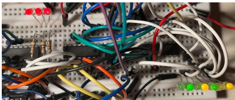
Slika 4.16. Ispravljeni izlaz kombinacije 0101.
