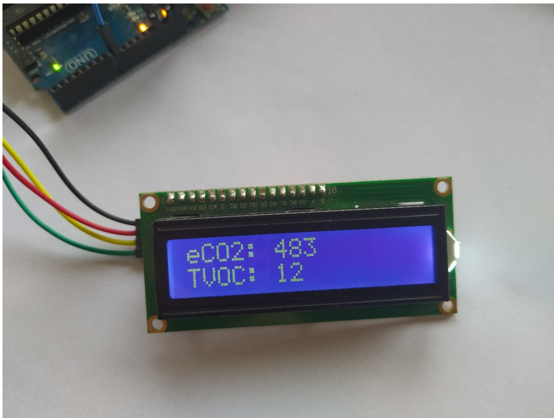
Slika 4.15. Ispis eCO2 i TVOC vrijednosti na LCD 16x2 zaslonu 5 minuta nakon uključenja
