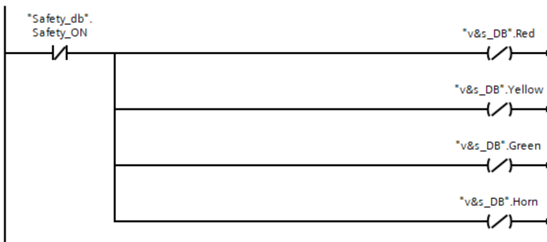
Slika 5.11. Semafor i sirena prilikom isključenog sigurnosnog načina. Izvor: Autor rada.
