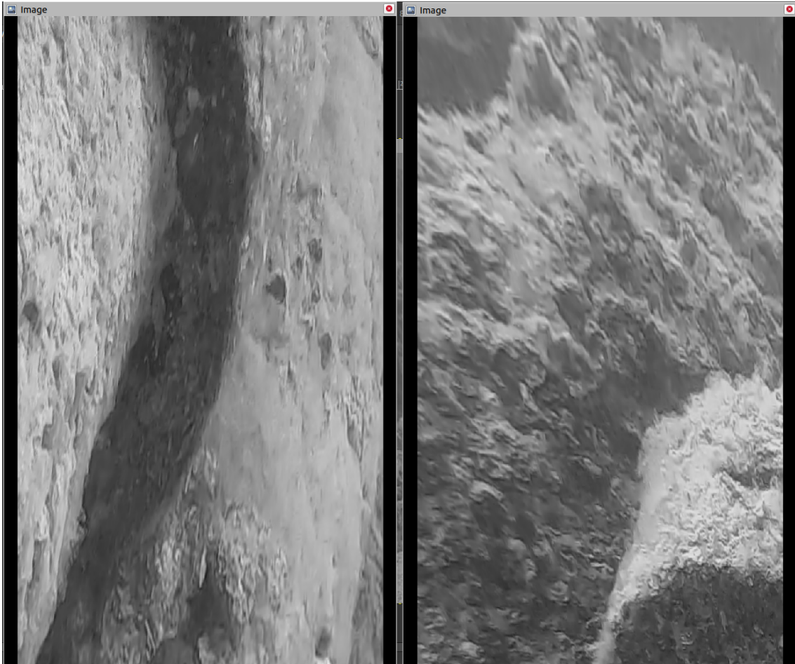
Slika 3.10: Primjer izobličenja slike kod stereo rektifikacije
