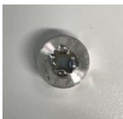
Slika 2.1: Membrana 2 \times 2 \text{ mm}^2 debljine 50 nm zalijepljena na držač.
