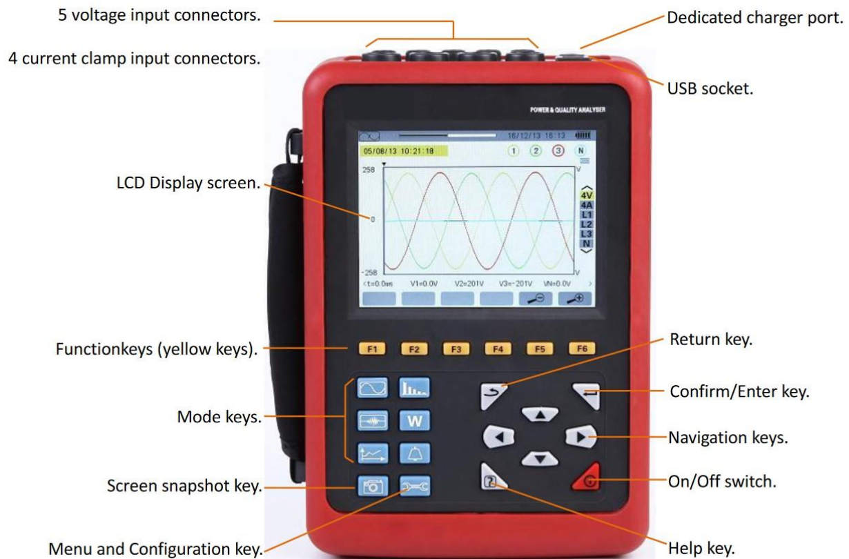
Slika 4.3. Izgled uređaja UNI-T UT285C[16]
