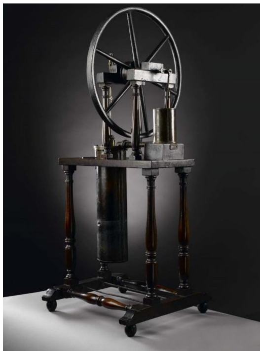
Slika 1.1 Najstariji model Stirlingova motora [2]
