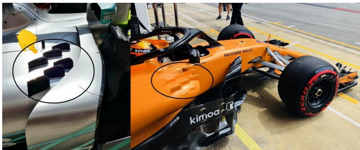
Slika 3.19. Generatori vrtloga kod Formule 1 [37]
