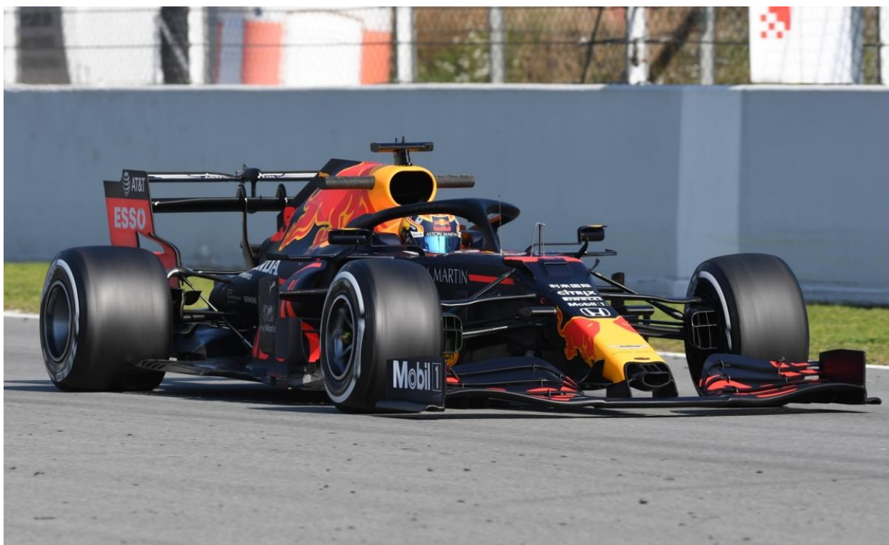
Slika 3.22. Automobil Formule 1 s aktiviranim DRS-om [40]
