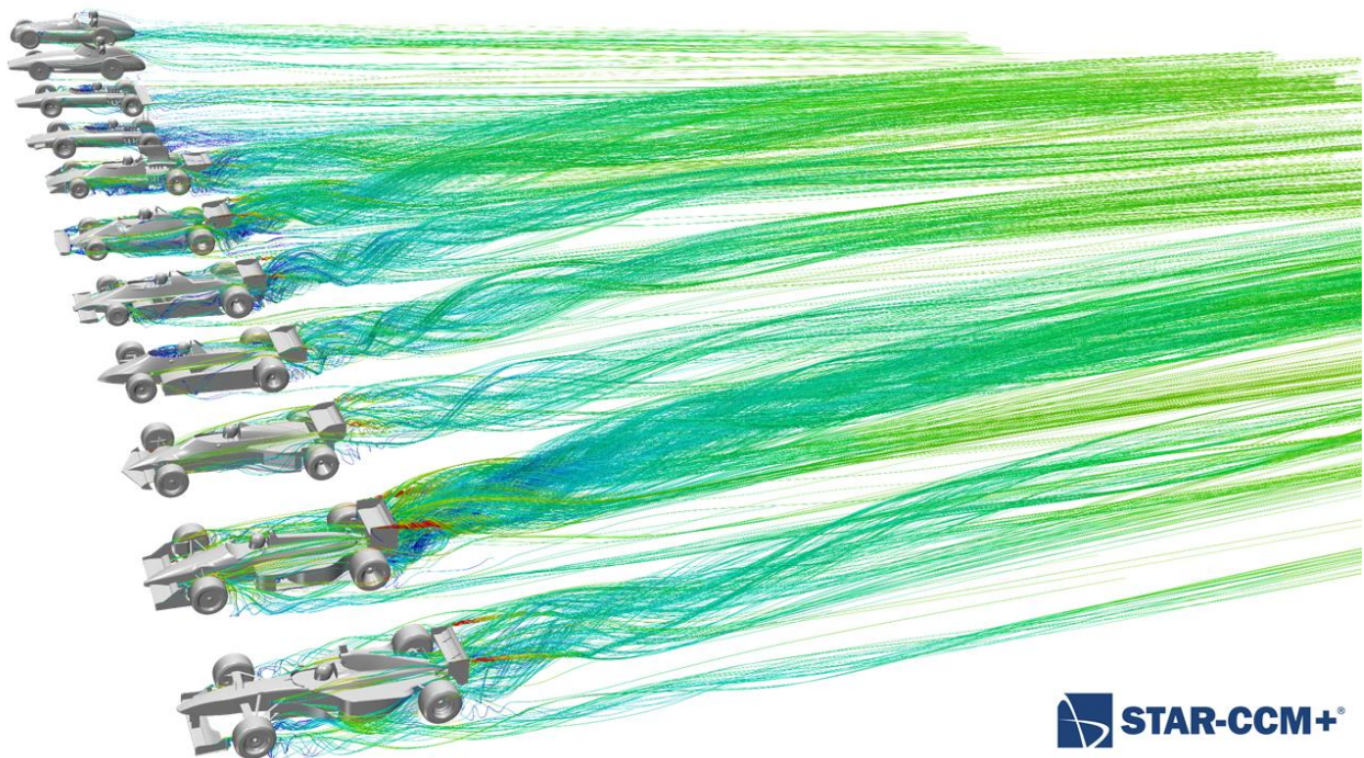
Slika 2.1. Primjer CFD analize Formula 1 automobila [18]
