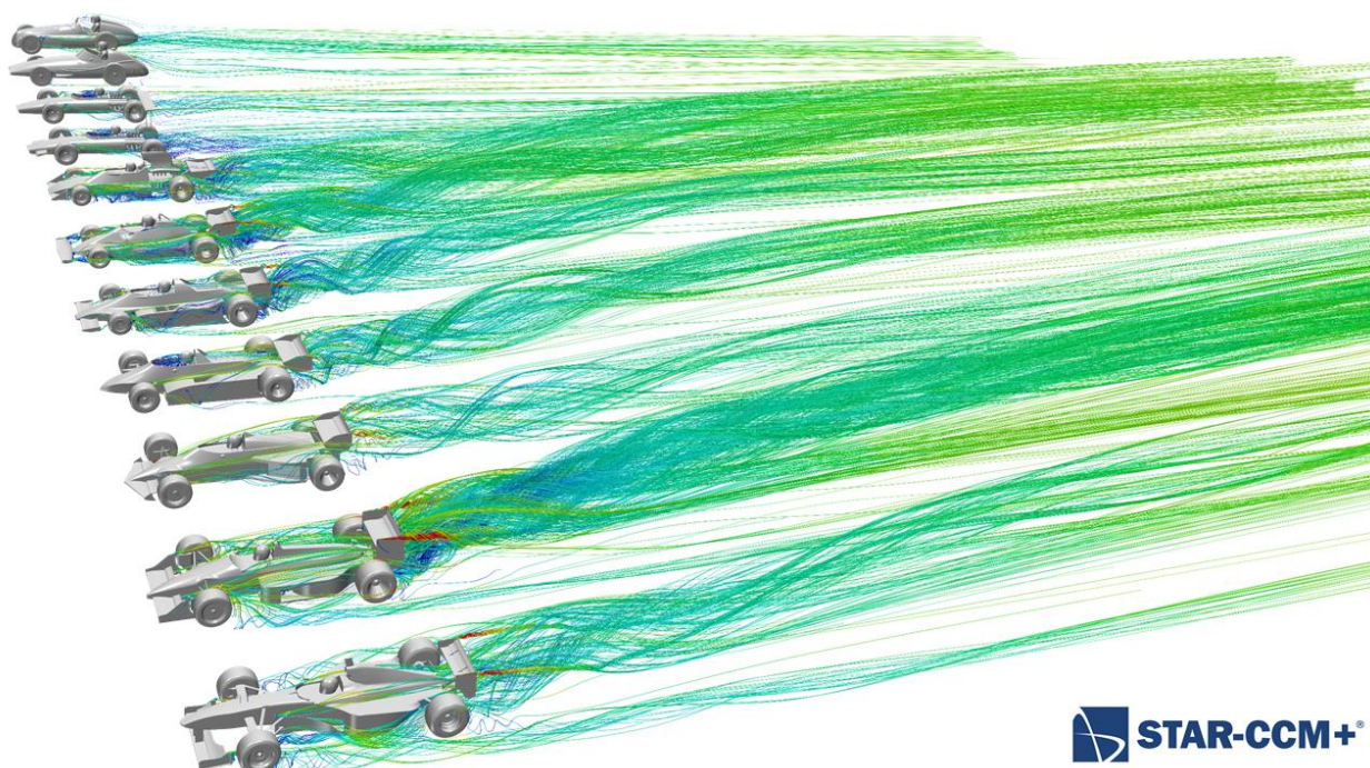
Slika 2.1. Primjer CFD analize Formula 1 automobila [18]
