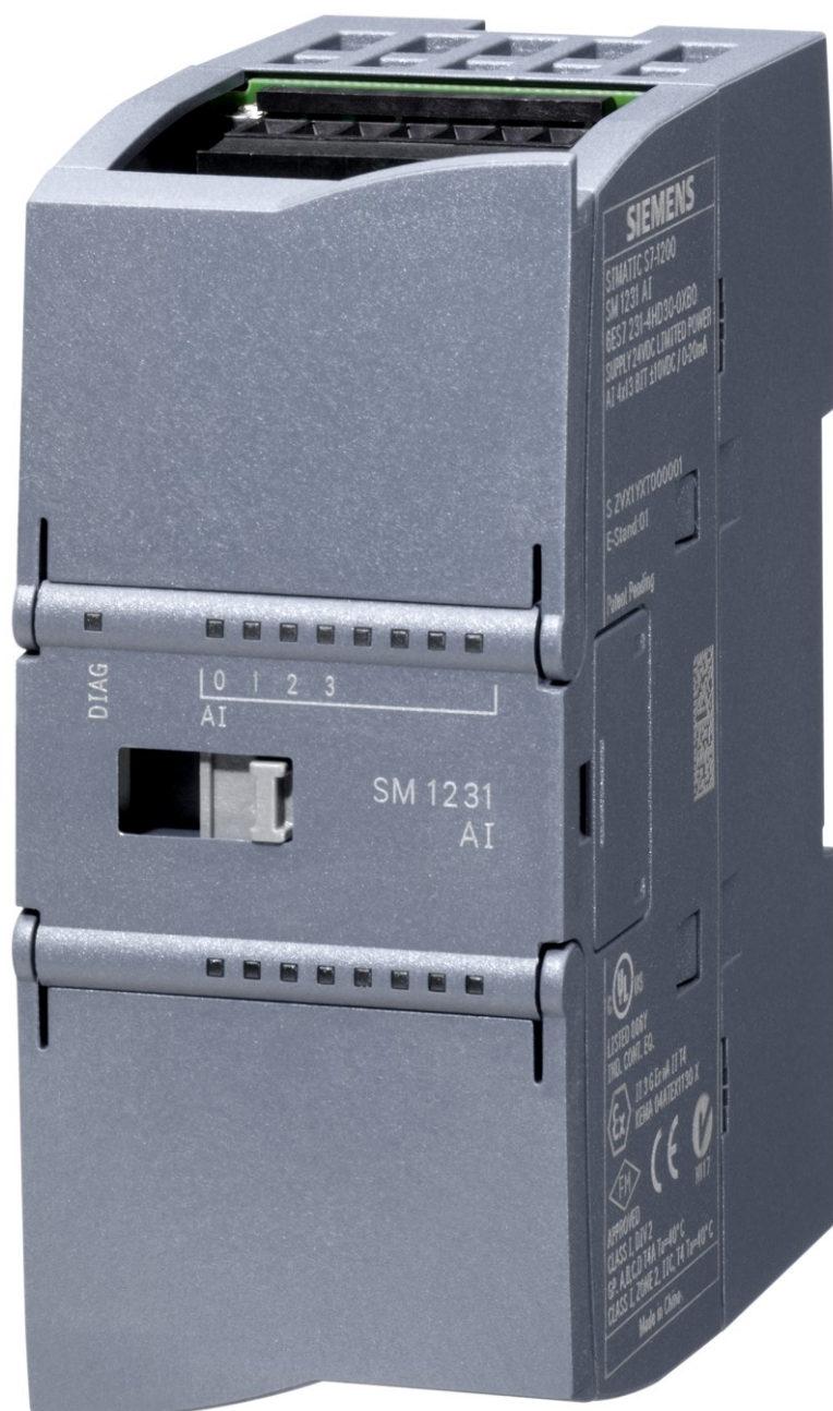
Slika 4.4. 6ES7231-4HF32-0XB0 Analogni modul [13]
