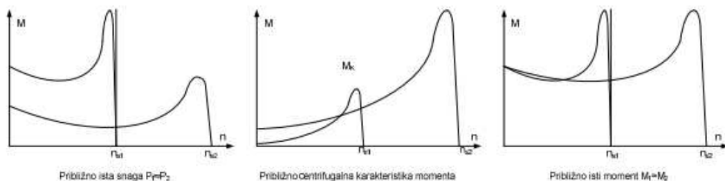
Slika 6.10. Momentna karakteristika za svaki spoj namota
