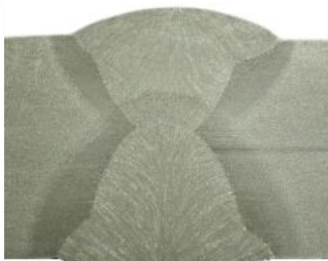
Slika 2.1. Presjek zavarenog spoja s karakterističnim zonama [5]
