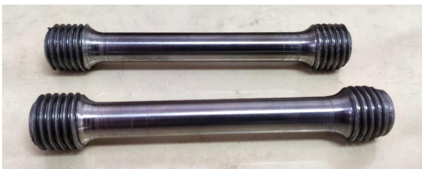
Slika 5.6. Uzorci za vlačno ispitivanje
