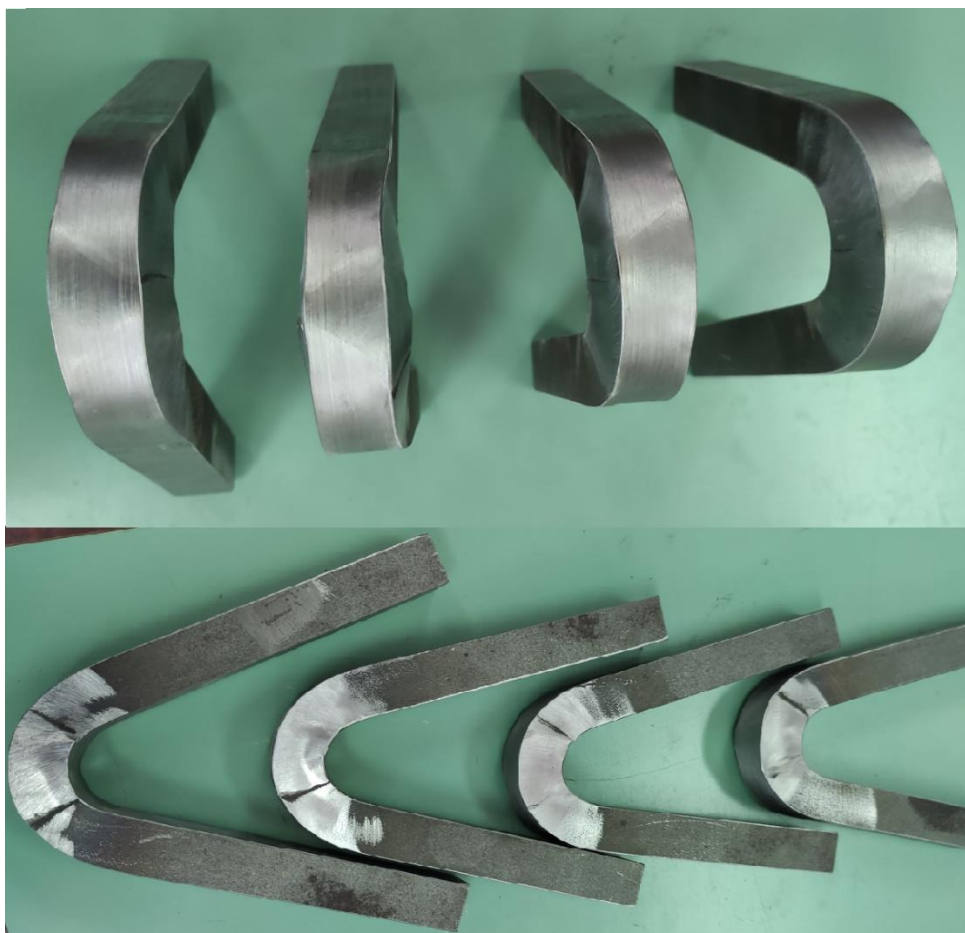
Slika 5.8. Uzorci ispitani savijanjem
