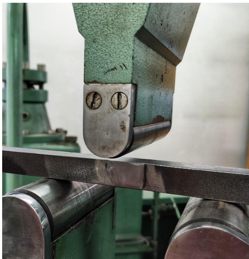
Slika 5.7. Savijanje ispitnog uzorka
