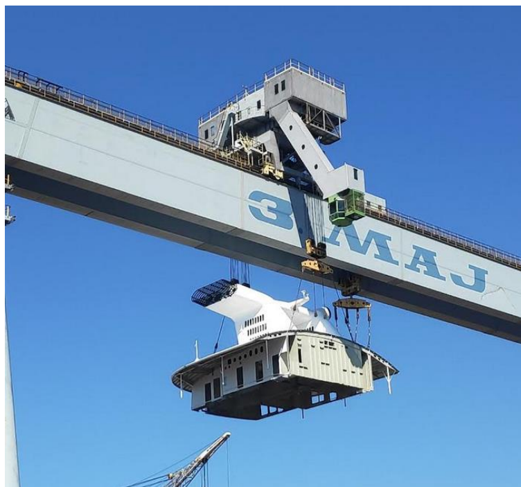
Slika 2.4. Montiranje VT sekcije na brod
