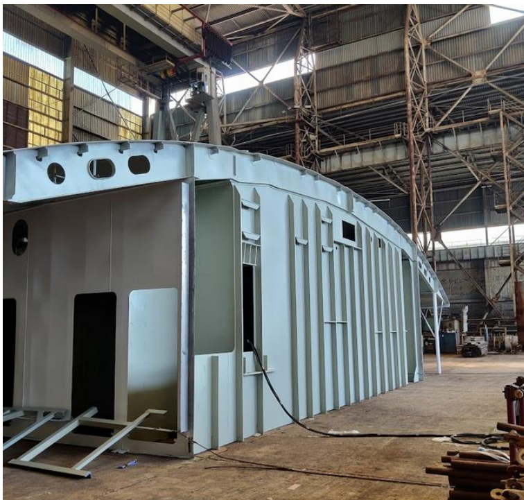
Slika 2.3. Okrenuta sekcija u hali za bojanje
