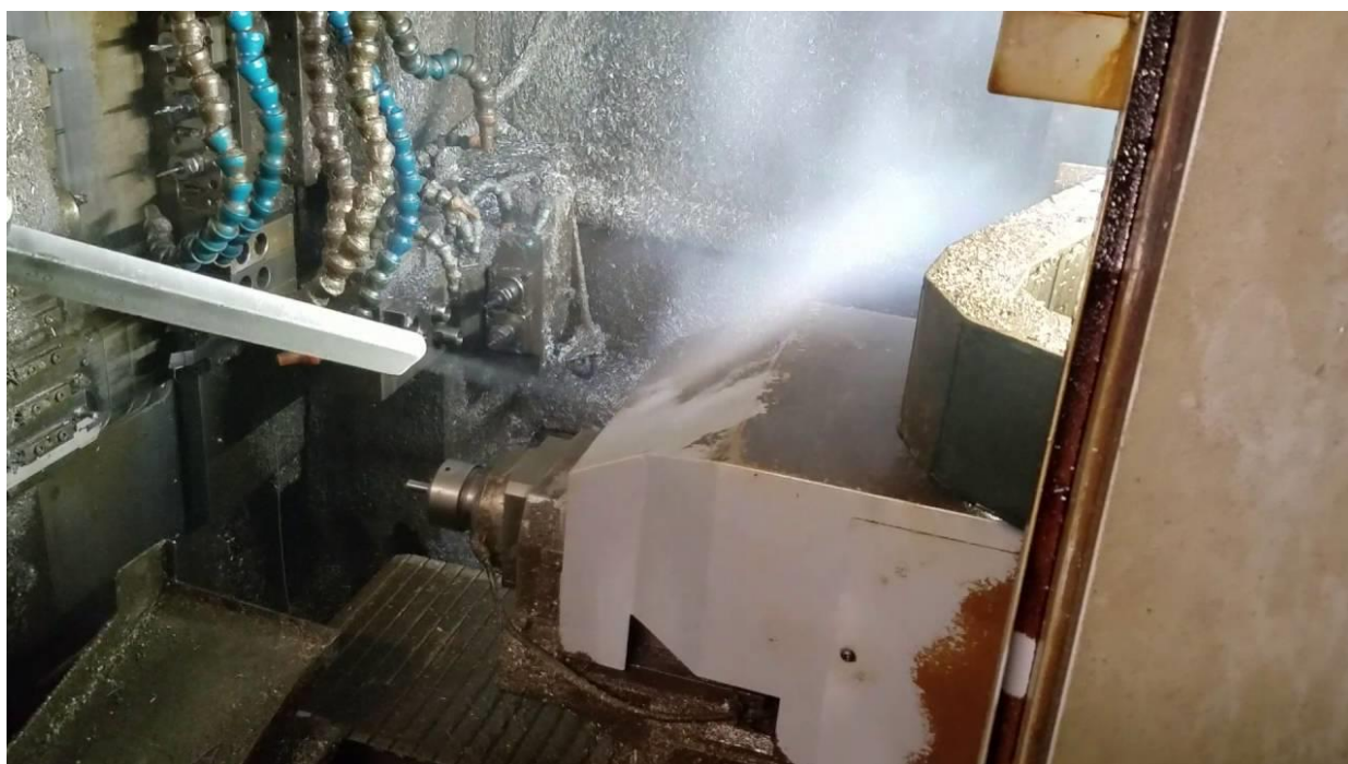
Slika 4.6. Primjena suhog leda (dry ice) prilikom obrade (sačmarenje) [33]
