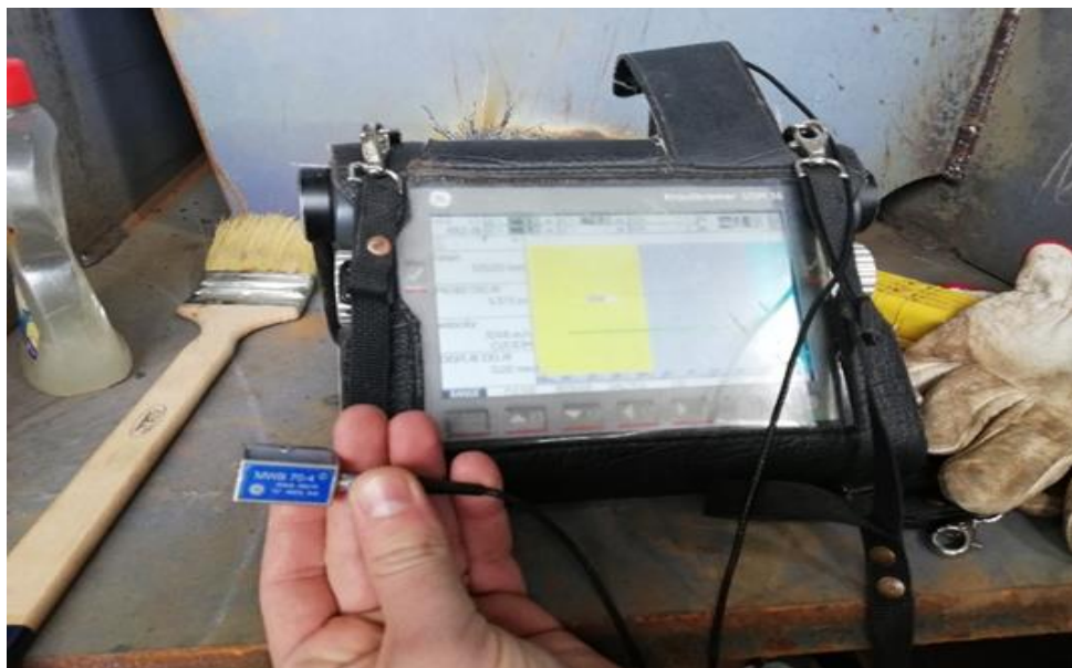
Slika 4.16 Ultrazvučno ispitivanje, oprema kojom se ispituje zavareni spoj, te prikazu postupak pripreme pred ispitivanje paljenje aparata te prikazuje memoriranje sa sondom od 70°. Priložen dokument kojim se potvrđuje korištenje izvornih slika brodogradilišta 3. Maj
