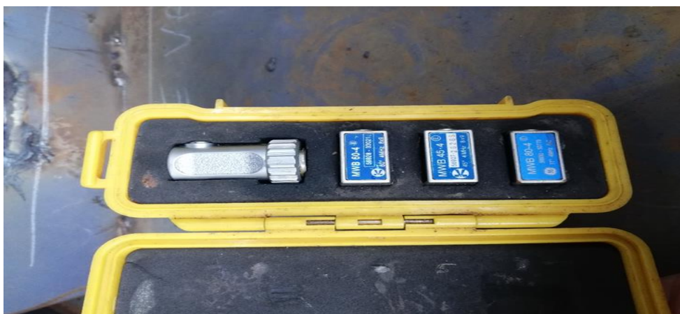
Slika 4.17 Sonde za ultrazvučno ispitivanje. Razni modeli kutova sonde . Ravna sonda, sonda pod kutem od 60°, 45° i 80°. Priložen dokument kojim se potvrđuje korištenje izvornih slika brodogradilišta 3. Maj
