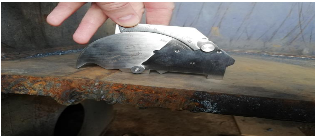
Slika 4.7 Praktični prikaz alata za mjerenje vizualnom kontrolom na zavarenom spoju. Priložen dokument kojim se potvrđuje korištenje izvornih slika brodogradilišta 3. Maj
