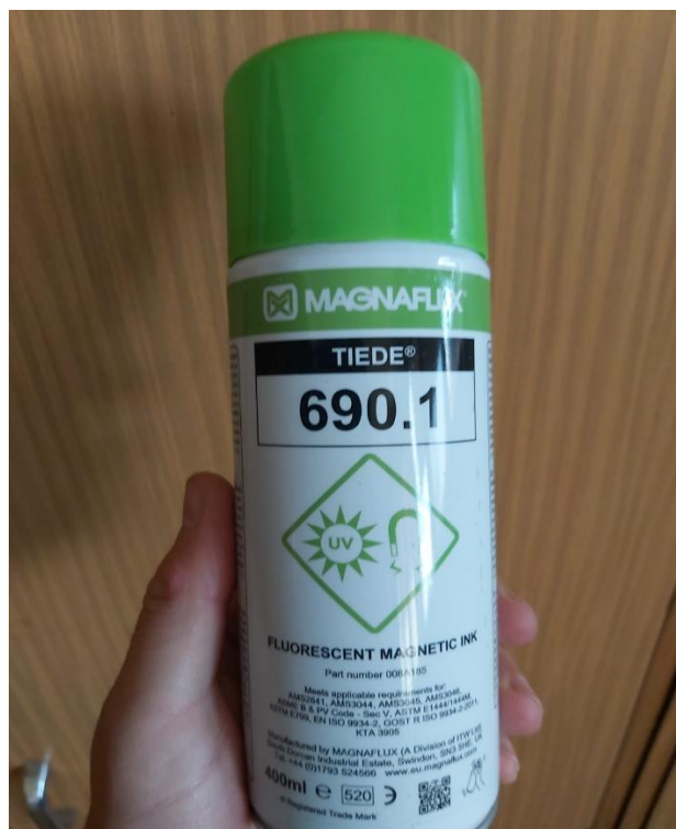
Slika 4.14 Prikaz flourescentne boje za prikaz nepravilosti koje nisu dostupne ili su teško vidljive. Priložen dokument kojim se potvrđuje korištenje izvornih slika brodogradilišta 3. Maj
