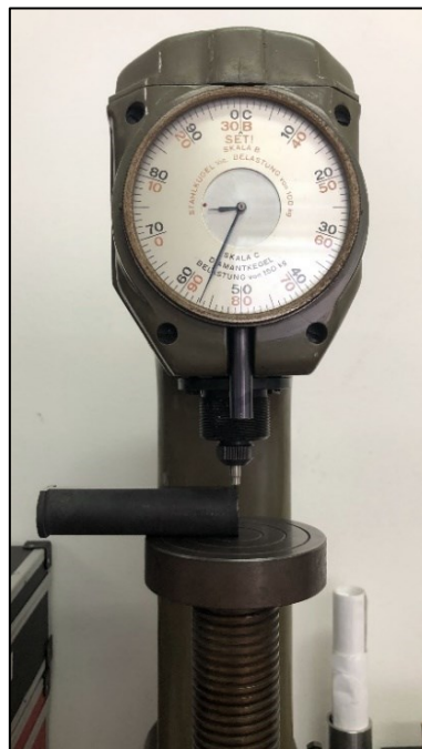
Slika 5.16. Ispitivanje tvrdoće na tvrdomjeru
