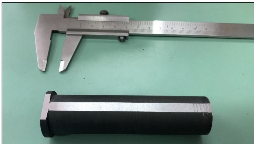
Slika 5.14. Postupak označavanja točaka ispitivanja po Jominyu
