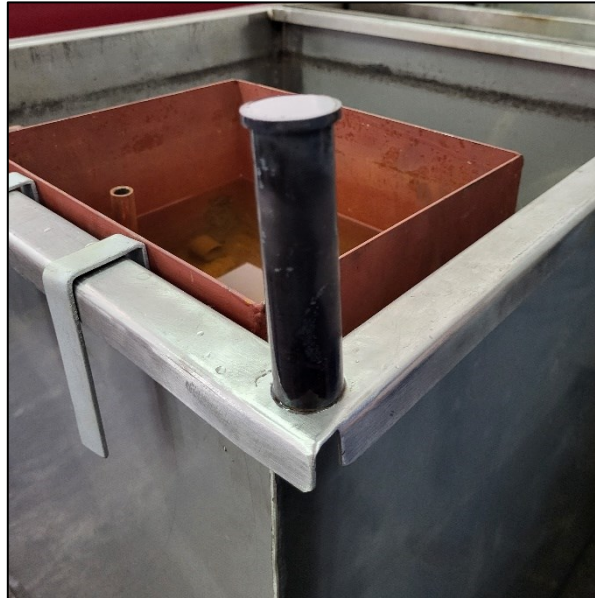
Slika 5.11. Jominyjev uzorak nakon gašenja
