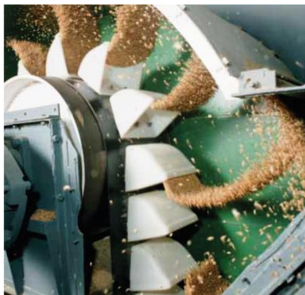
Slika 3.3 Centrifugalno pražnjenje žitarica [4]
