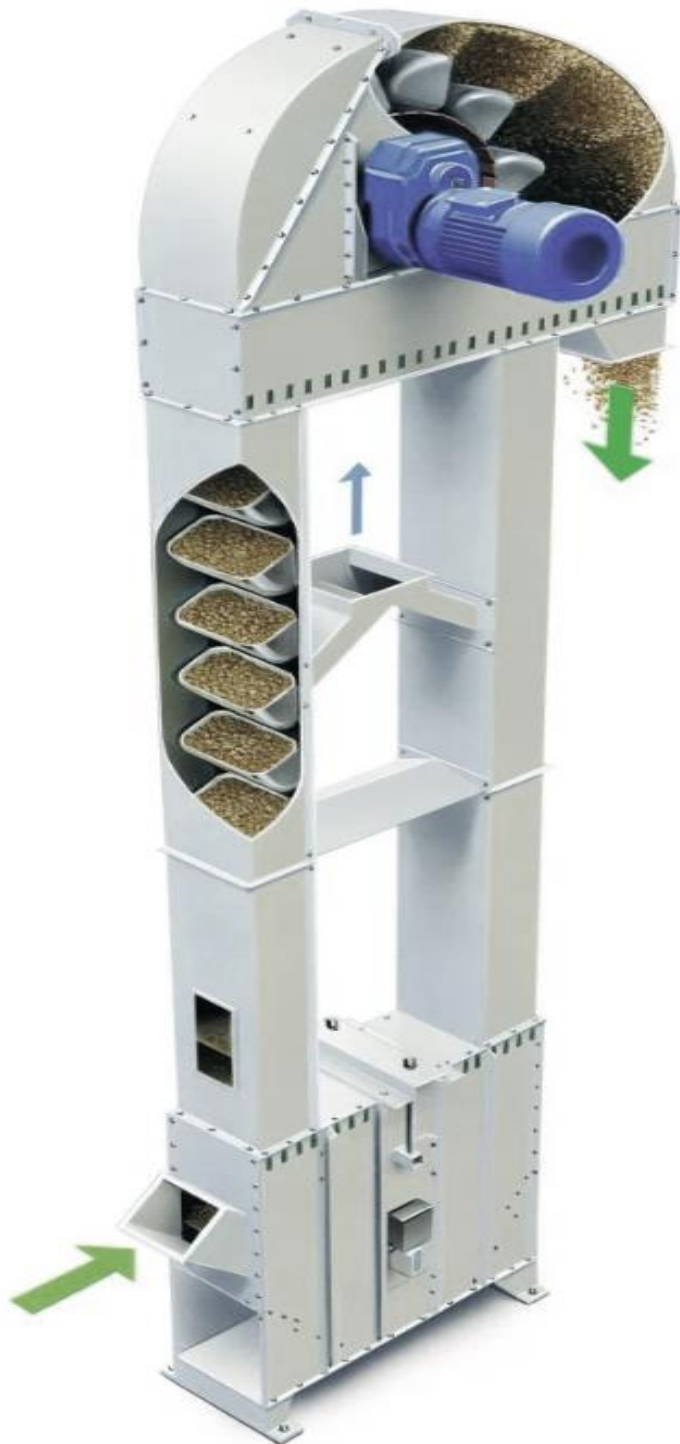
Slika 3.1 Vjedreni elevator za transport žita [2]
