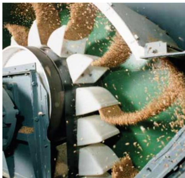
Slika 3.3 Centrifugalno pražnjenje žitarica [4]
