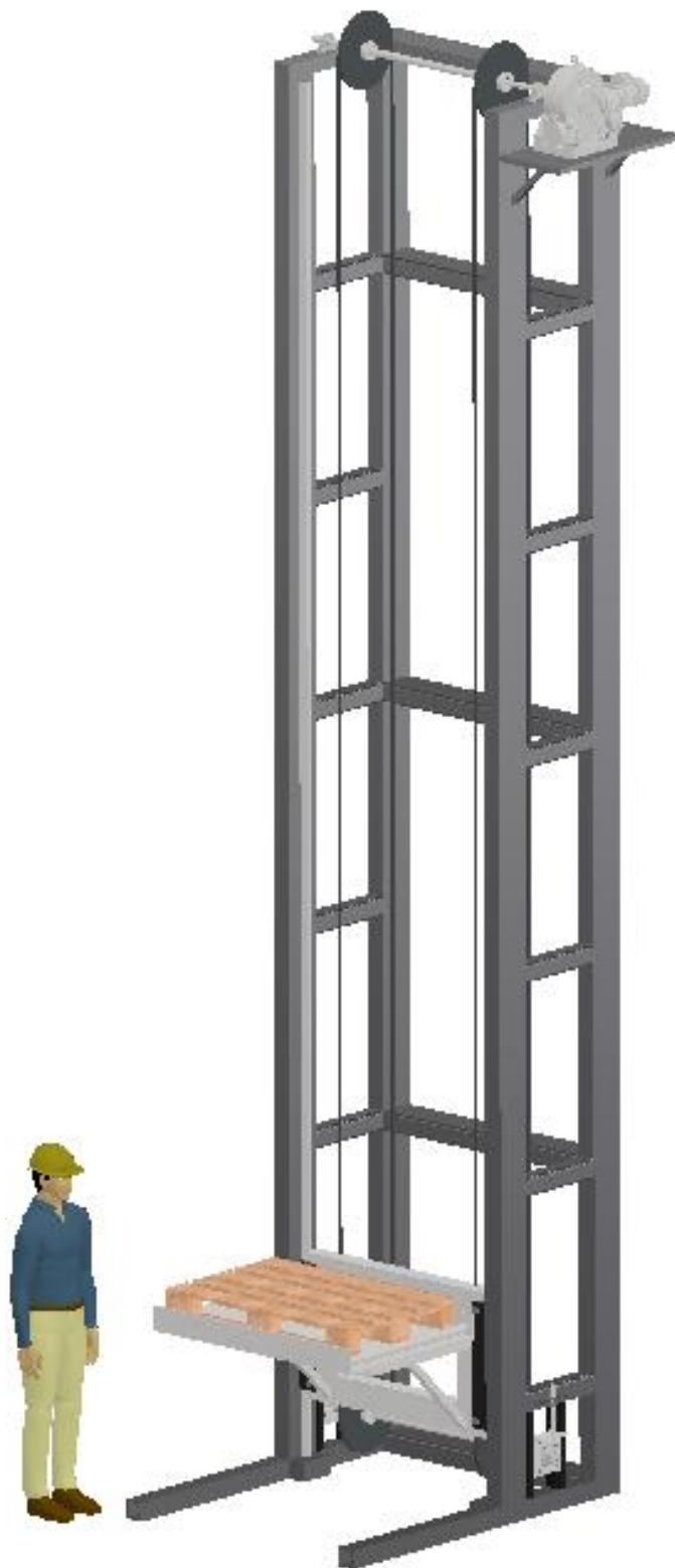
Slika 10.1 Kompletan prikaz elevatora
