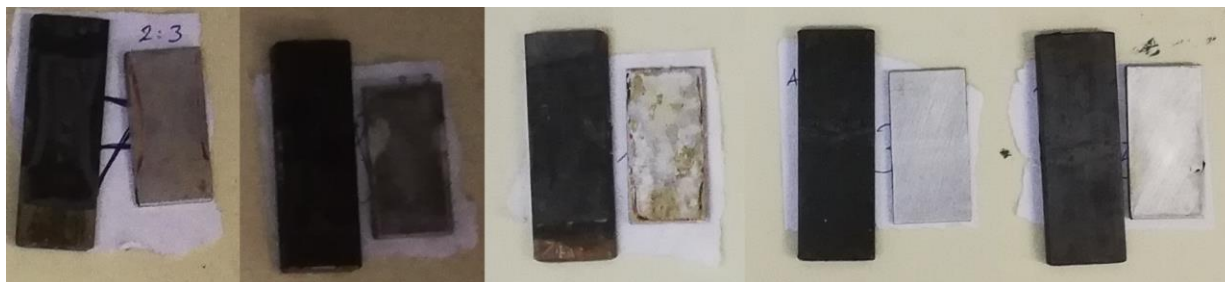
Slika 6.37. Izgled ispitnih uzoraka u ovisnosti o vrsti medija: 7 (zemlja), 9 (slatka voda), 11 (morska voda), 23 (zemlja (R)) i 25 (slatka voda (R)). Omjer površina aluminija i čelika 2:3
