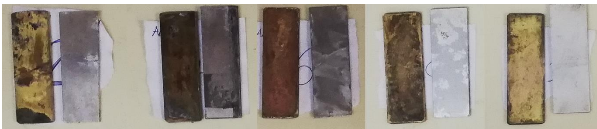
Slika 6.35. Izgled ispitnih uzoraka u ovisnosti o vrsti medija: 2 (zemlja), 4 (slatka voda), 6 (morska voda), 20 (zemlja (R)) i 22 (slatka voda (R)). Omjer površina aluminija i mjedi 1:1
