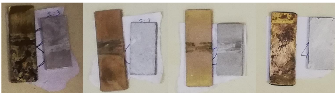
Slika 6.39. Izgled ispitnih uzoraka u ovisnosti o vrsti medija: 8 (zemlja), 10 (slatka voda), 12 (morska voda) i 24 (zemlja (R)). Omjer površina aluminija i mjedi 2:3
