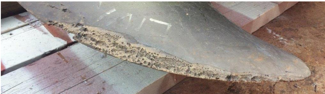
Slika 5.21. Kavitacija brodskog propelera [44]
