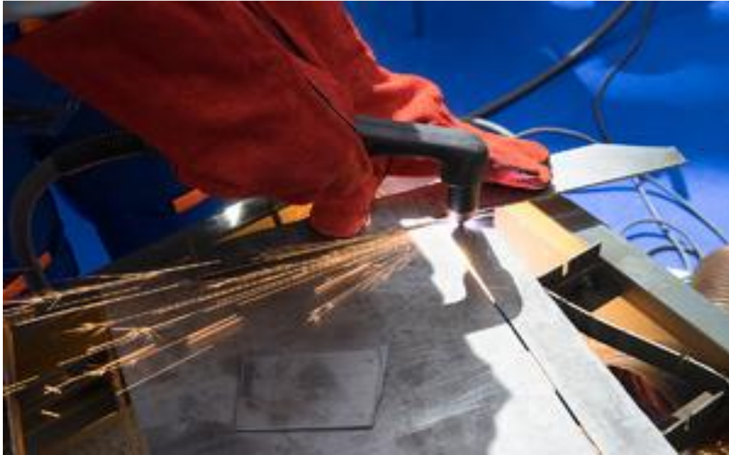
Slika 4.6. Ručno rezanje plazmom [12]
