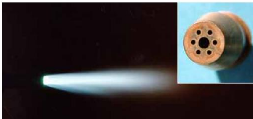
Slika 5.7. Dizajn mlaznice i acetilenski plinski mlaz [16]
