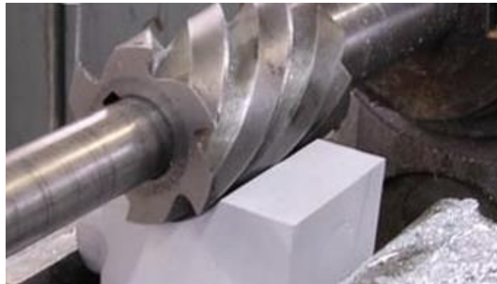
Slika 3.6. Obimno ravno glodanje [3]
