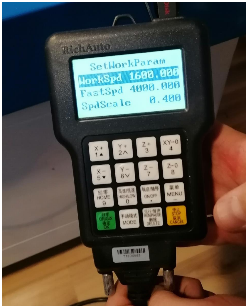
Slika 6.20. Upravljačka jedinica RichAuto DSP A11
