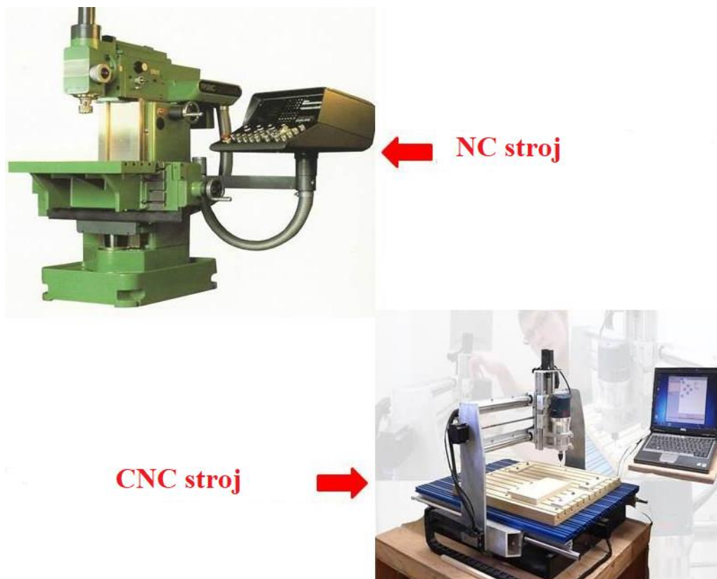
Slika 3.10. NC i CNC stroj [5]
