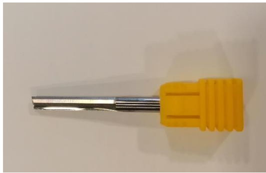
Slika 6.17. Dvorezno glodalo promjera 4 mm
