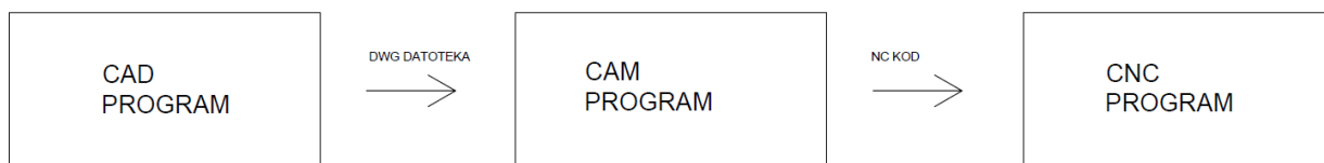
Slika 5.1. proces izrade NC koda
