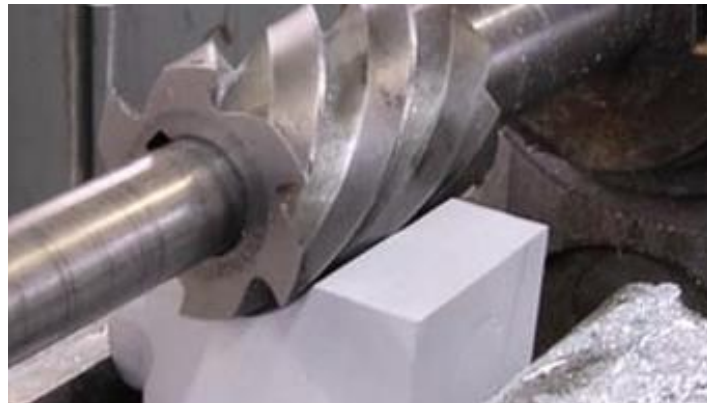
Slika 3.6. Obimno ravno glodanje [3]
