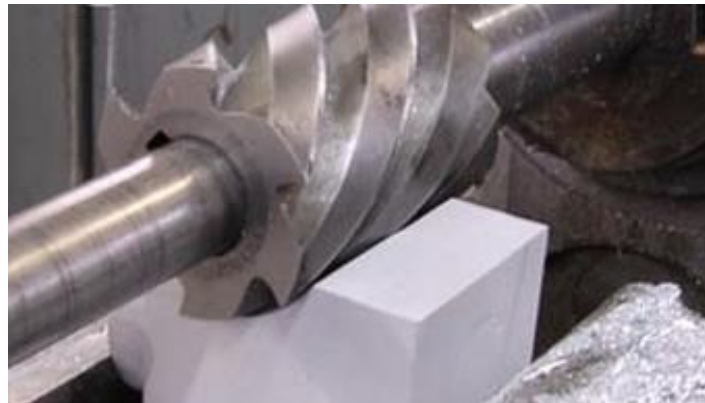
Slika 3.6. Obimno ravno glodanje [3]
