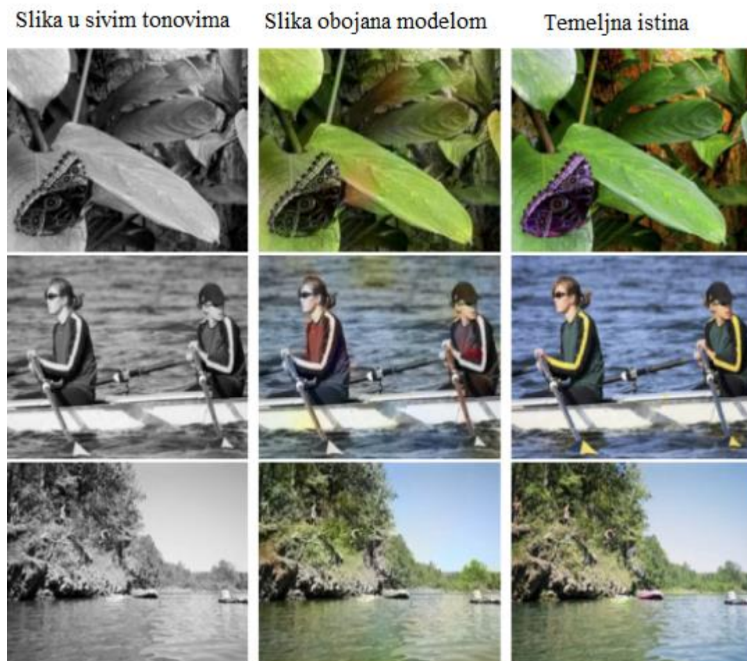
Slika 3.3 Usporedba rezultata dobivenih korištenjem duboke koalarizacije za bojanje (srednji stupac) sa slikom u sivim tonovima (lijevi stupac) i stvarne slike (desni stupac)[13]
