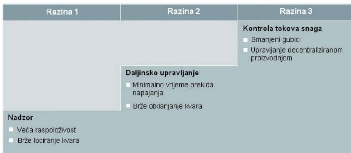
Slika 3.4. Razine automatizacije digitaliziranih transformatorskih stanica [10]
