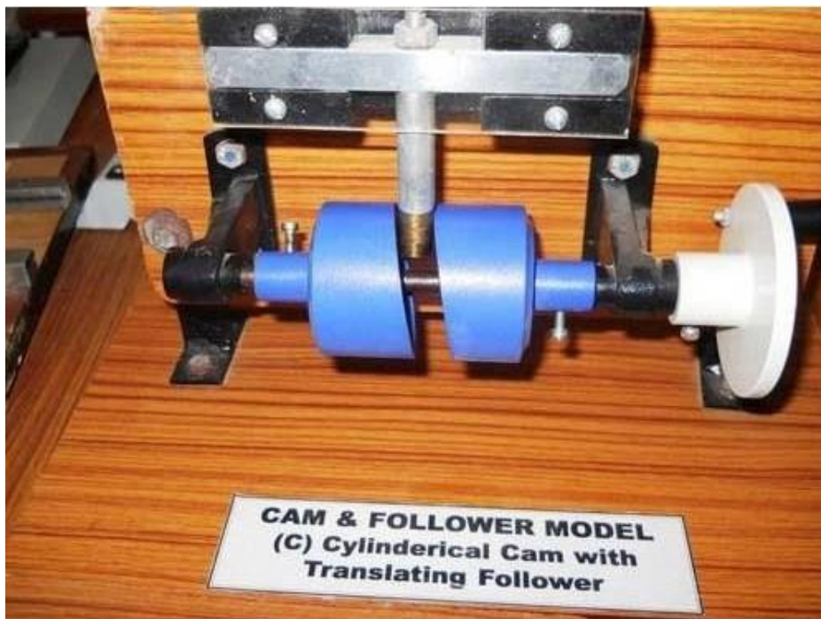
Slika 1.1. Cilindrični krivuljni mehanizam s translacijskim podizačem[3]
