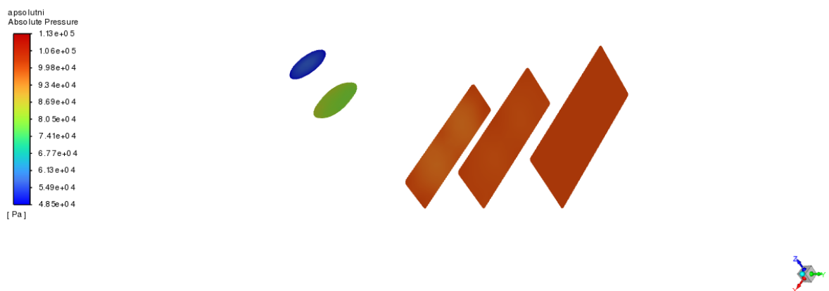
Slika 7.7. Konture apsolutnog tlaka po presjecima
