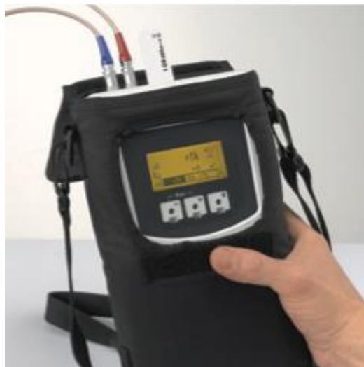
Slika 4.4. Putno računalo korištenog ultrazvučnog mjerača [9]
