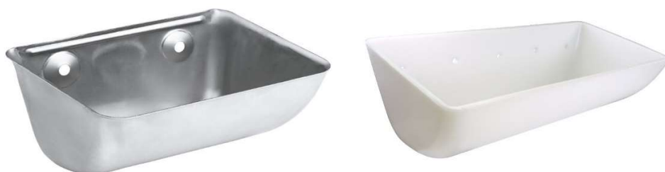
Slika 2.5. Vjedro od nehrđajućeg čelika i vjedro izrađeno od polietilena visoke gustoće [8]
