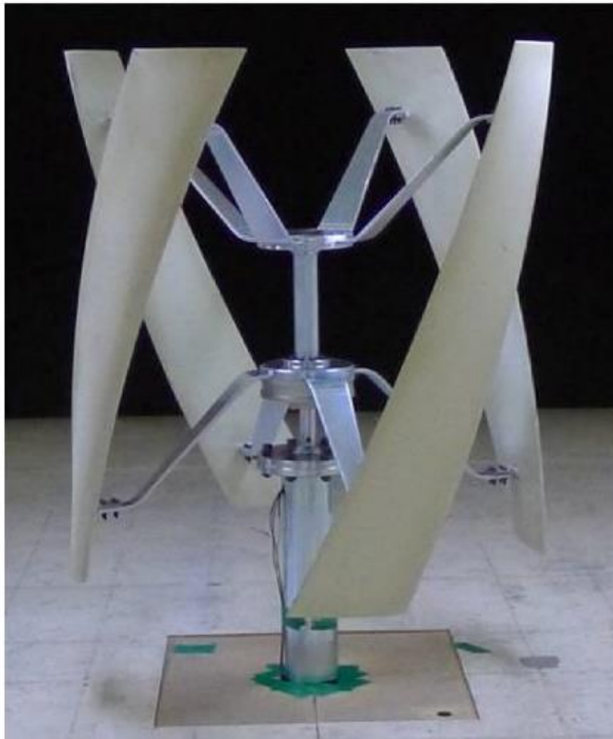
Slika 2.5 "Helical" izvedba vjetroturbine s vertikalnom osi vrtnje
