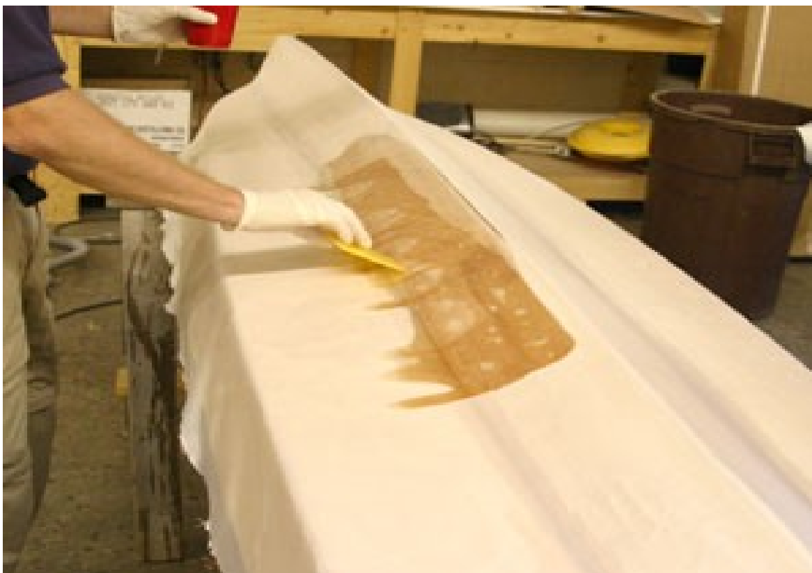
Slika 3.8. Raspršivanje epoksidne smjese po površini tkanine [19]
