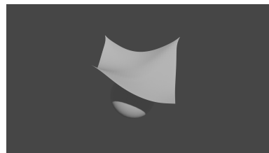
Slika 5.5 Prikaz simulacije sudara sa sferom sa pridodanim oprugama smicanja u model
