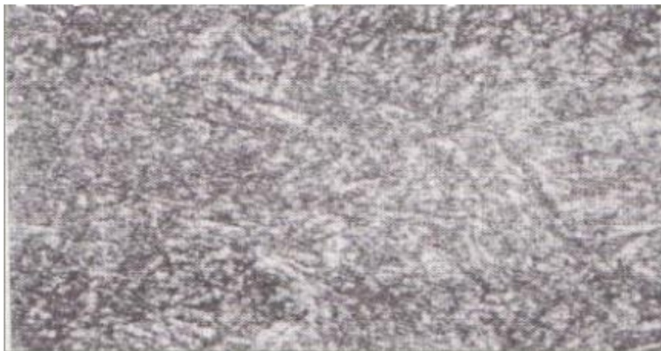
Slika 4.14. Mikrostruktura čelika (0,98% ugljika) poslije pretvorbe u bainit [12]
