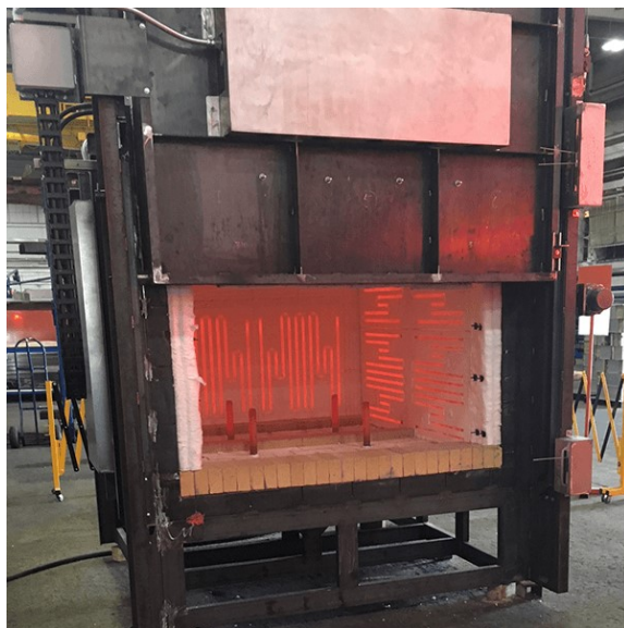
Slika 6.1. Peć u obliku kutije (eng. Box Furnace) [13]
