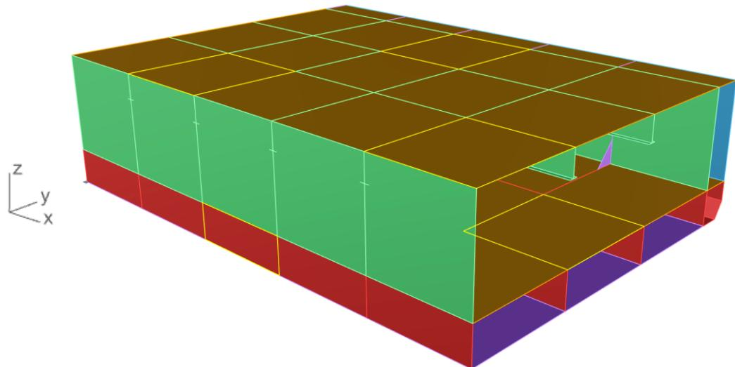
Slika 4.16. Podjela primarne strukture – Parcijalni geometrijski model.
