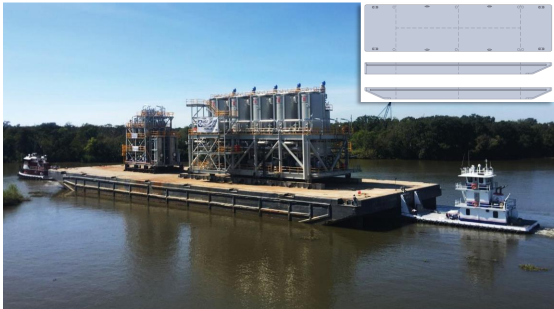
Slika 2.4. Deck barge – teretna barža [3].
