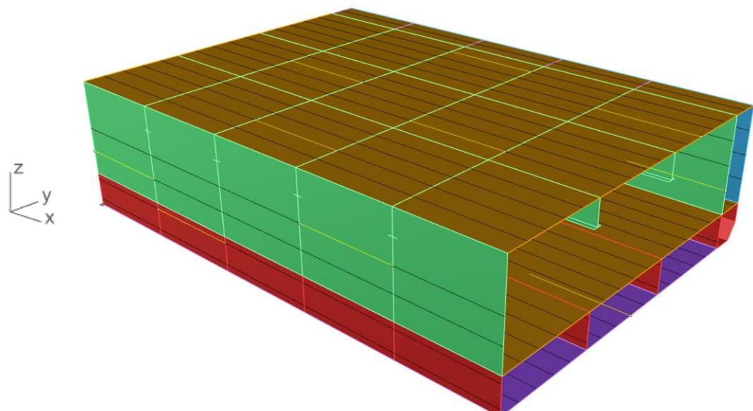
Slika 4.17. Podjela sekundarne strukture – Parcijalni geometrijski model.
