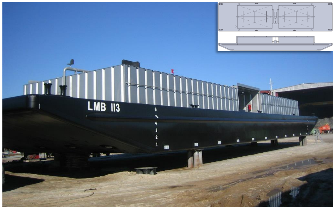
Slika 2.8. Liquid mud barges – barža za transport otpadnih tekućina sa naftnih bušotina [3].
