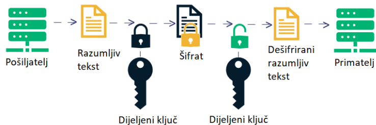
Slika 2.2 Slanje poruke pomoću simetričnog kriptosustava
