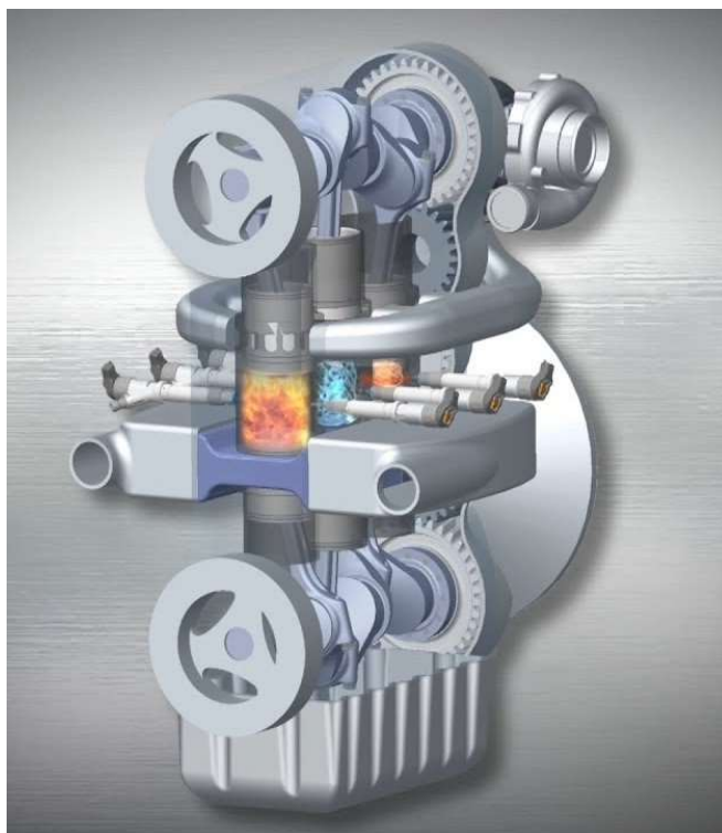
Slika 3.2 Pojednostavljeni prikaz Achatesa motora s nasuprotnim klipovima [6]
