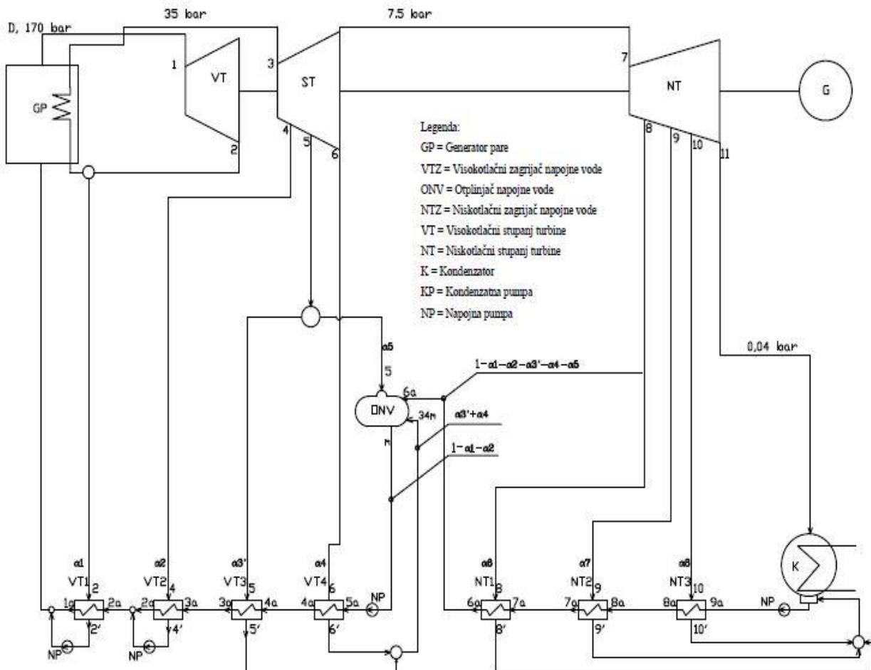
Slika 4.1. Shema Termoenergetskog postrojenja nazivne snage 700 MWel
