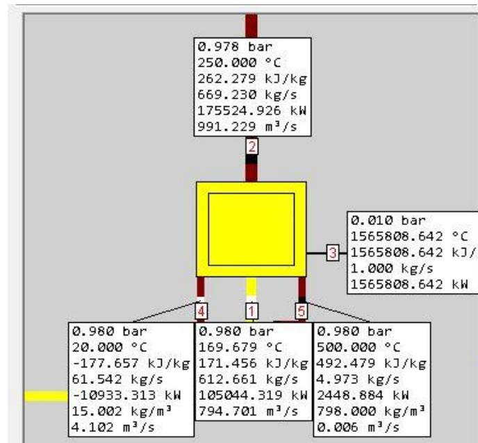
Slika 5.18. Shema komore izgaranja, korišteno gorivo – ugljen
