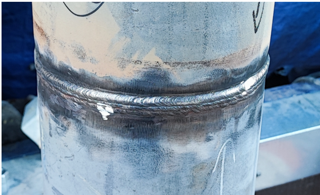
Slika 4.1. Prikaz zavarenog spoja strojnog dijela MS.20-DI.41
