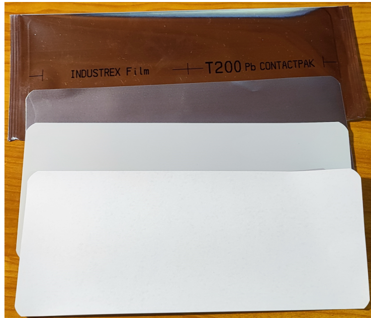
Slika 4.9. Neeksponirani film izvađen iz vakuum pakiranja
