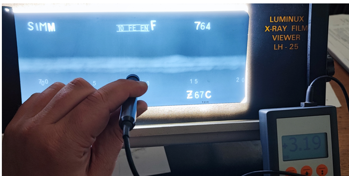
Slika 4.22. Provjera zacrtnjenja radiograma denzitometrom
