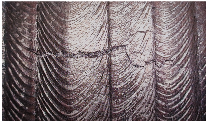
Slika 3.5. Razgranata pukotina u zavaru martenzitnog čelika [5]
