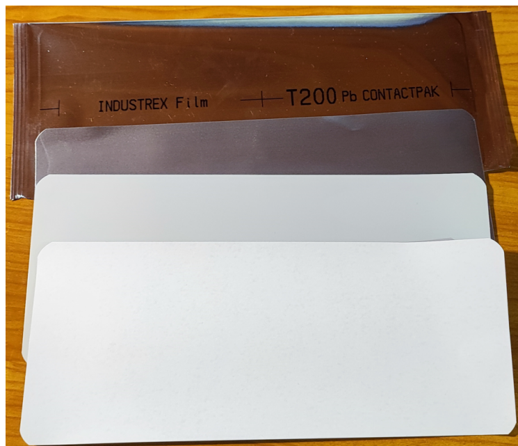
Slika 4.9. Neeksponirani film izvađen iz vakuum pakiranja
