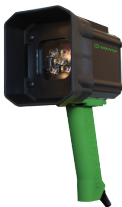
Slika 2.10. Prikaz UV lampe proizvođača Magnaflux [4]
