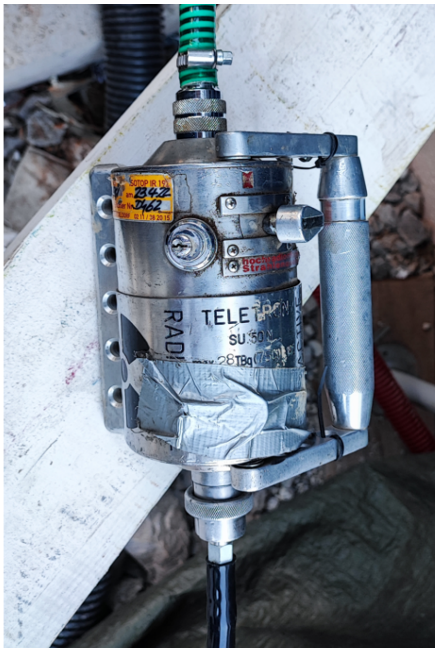
Slika 4.16. Prikaz defektoskopa sa spojenim daljinskim upravljačem (dolje) i vodilicom (gore)
