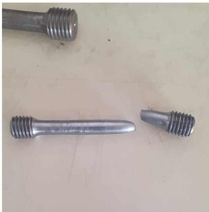
Slika 7.11. Testna epruveta 1 nakon testa vlačne čvrstoće
