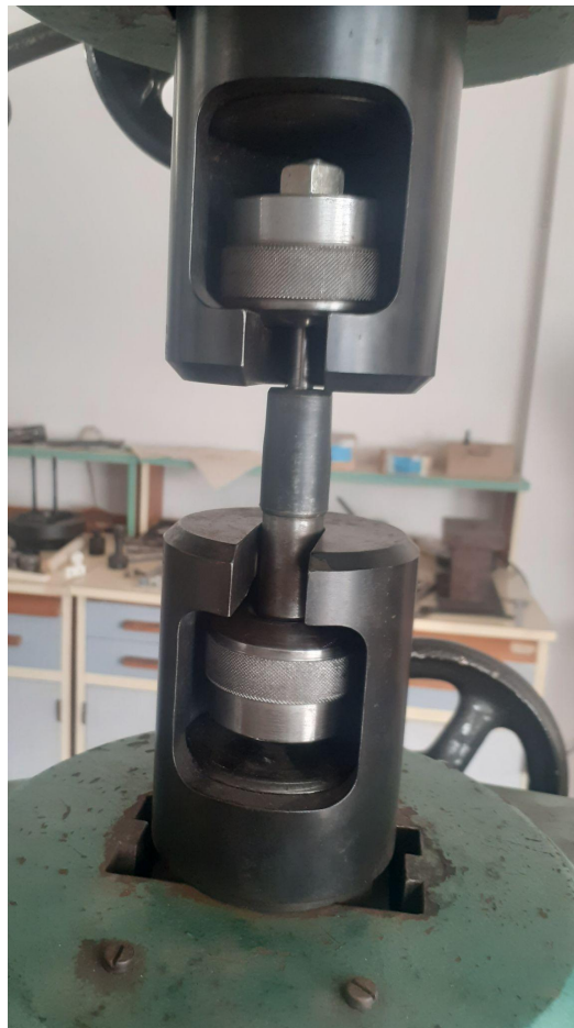
Slika 7.9. Testna epruveta u kidalici spremna za test
