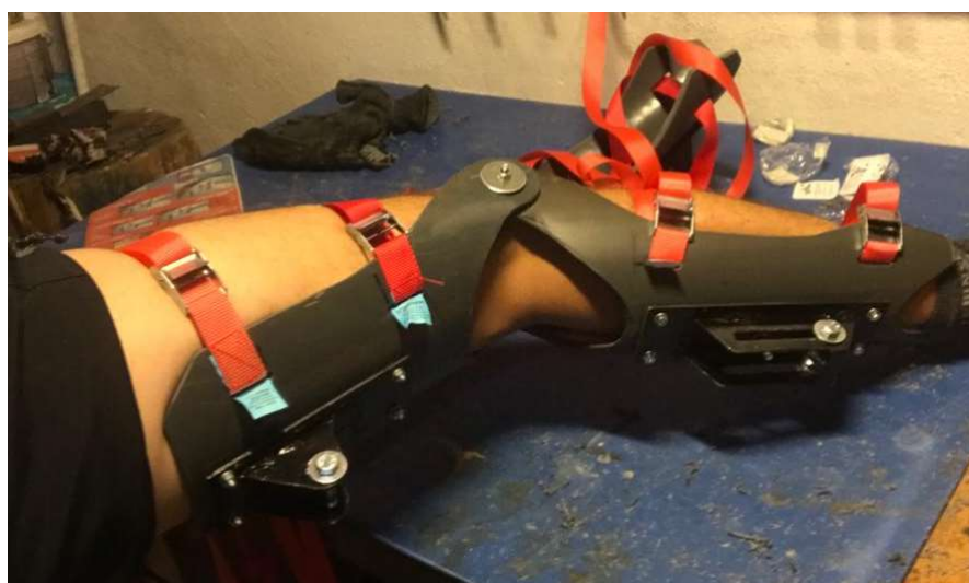
Slika 6.20. Montiranje remena za zatezanje
