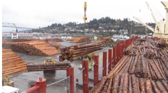
Slika 2.13. Krcanje trupaca na brod za prijevoz općeg tereta
