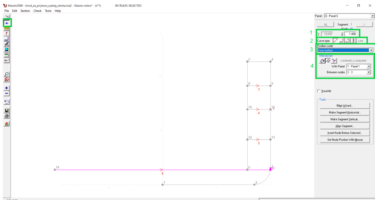
Slika 4.11. Nodes, 1 - koordinate; 2 - oblik panela; 3 - kategorija panela; 4 - sjecište panela
