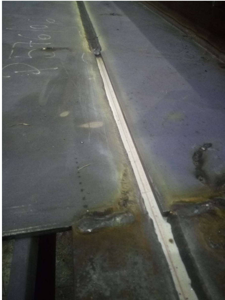
Slika 4.6.2 Priprema za sučeljni spoj
