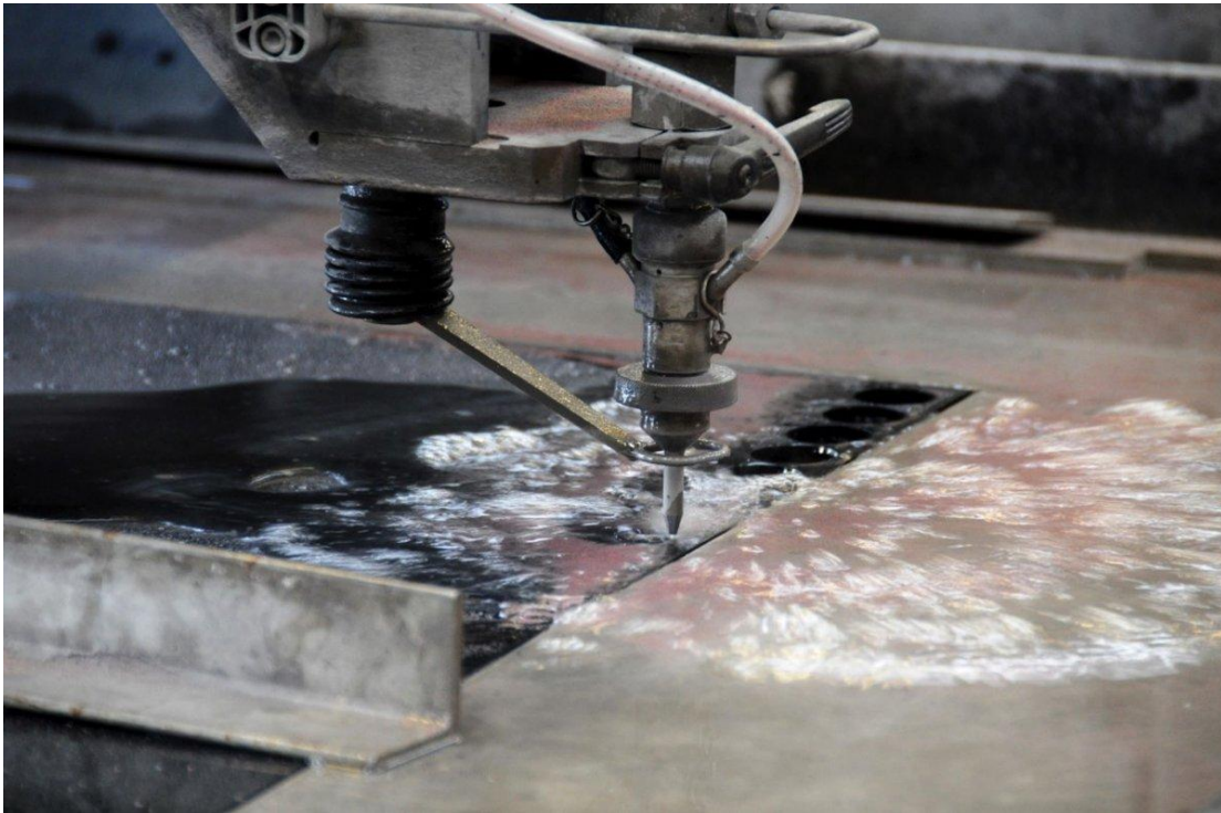
Slika 3.1.2. Rezanje lima vodenim mlazom [9].
