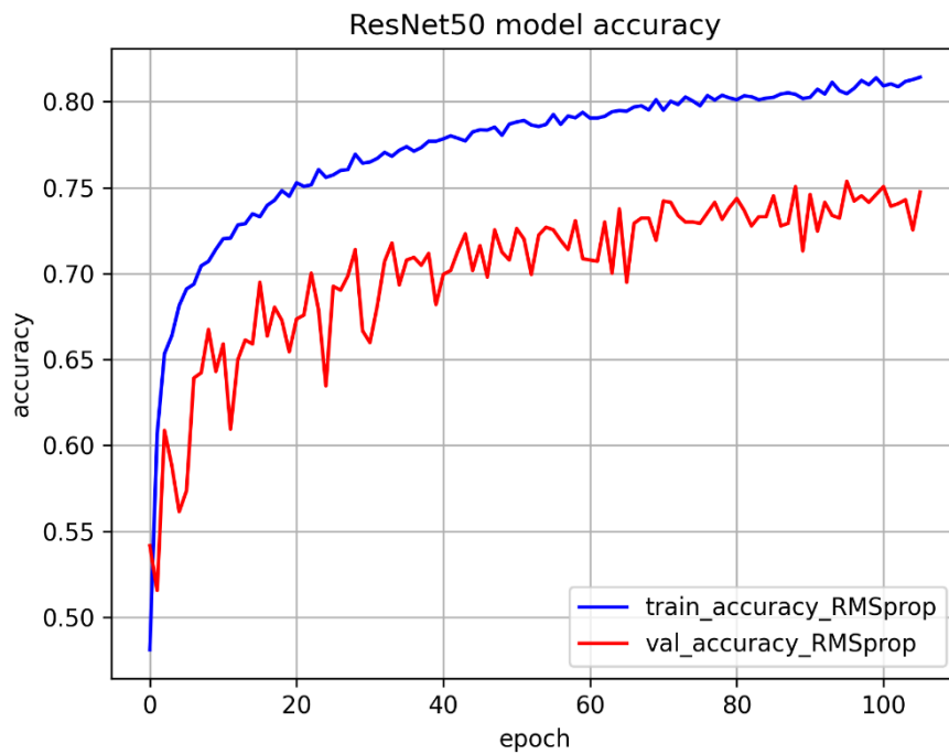
Slika 32. Točnost ResNet50 modela koristeći RMSprop optimizacijski algoritam
