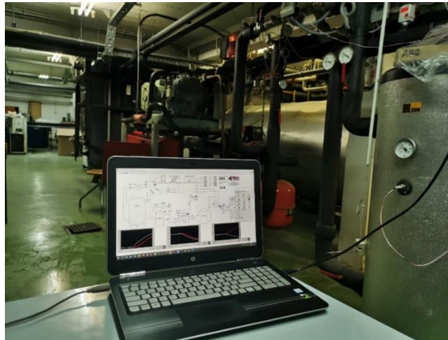
Slika 5.9 Računalo povezano sa sustavima za akviziciju korišteno za praćenje i pohranjivanje mjerenih temperatura i protoka vode i temperatura parafina
