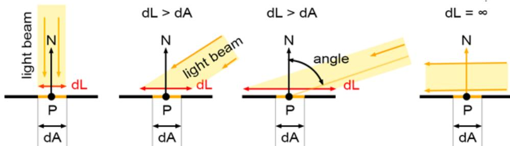
Slika 6.1 Kutori pada svjetlosnog snopa na površinu [9]
