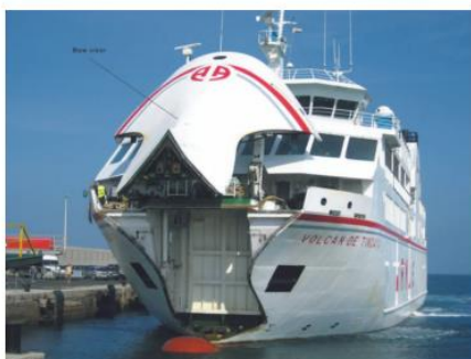
c) Pramčana rampa
