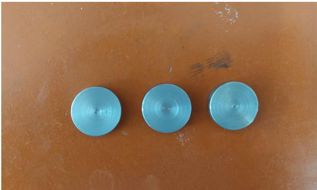
Slika 5.1. Ispitni uzorci od niskolegiranog čelika 42CrMo4
