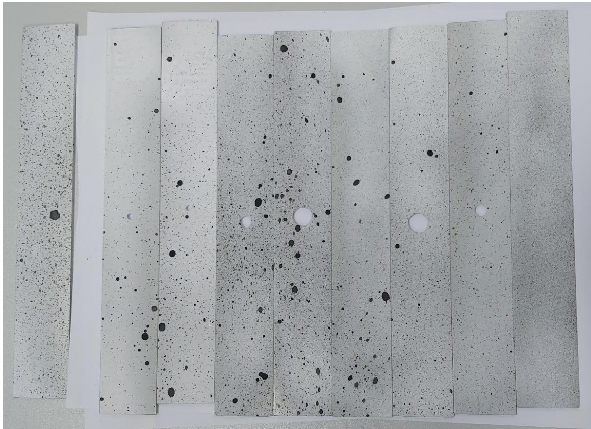
Slika 6.8: Izrađeni uzorci na aluminijskim ispitnim pločama s različitim veličinama promjera središnjeg provrta
