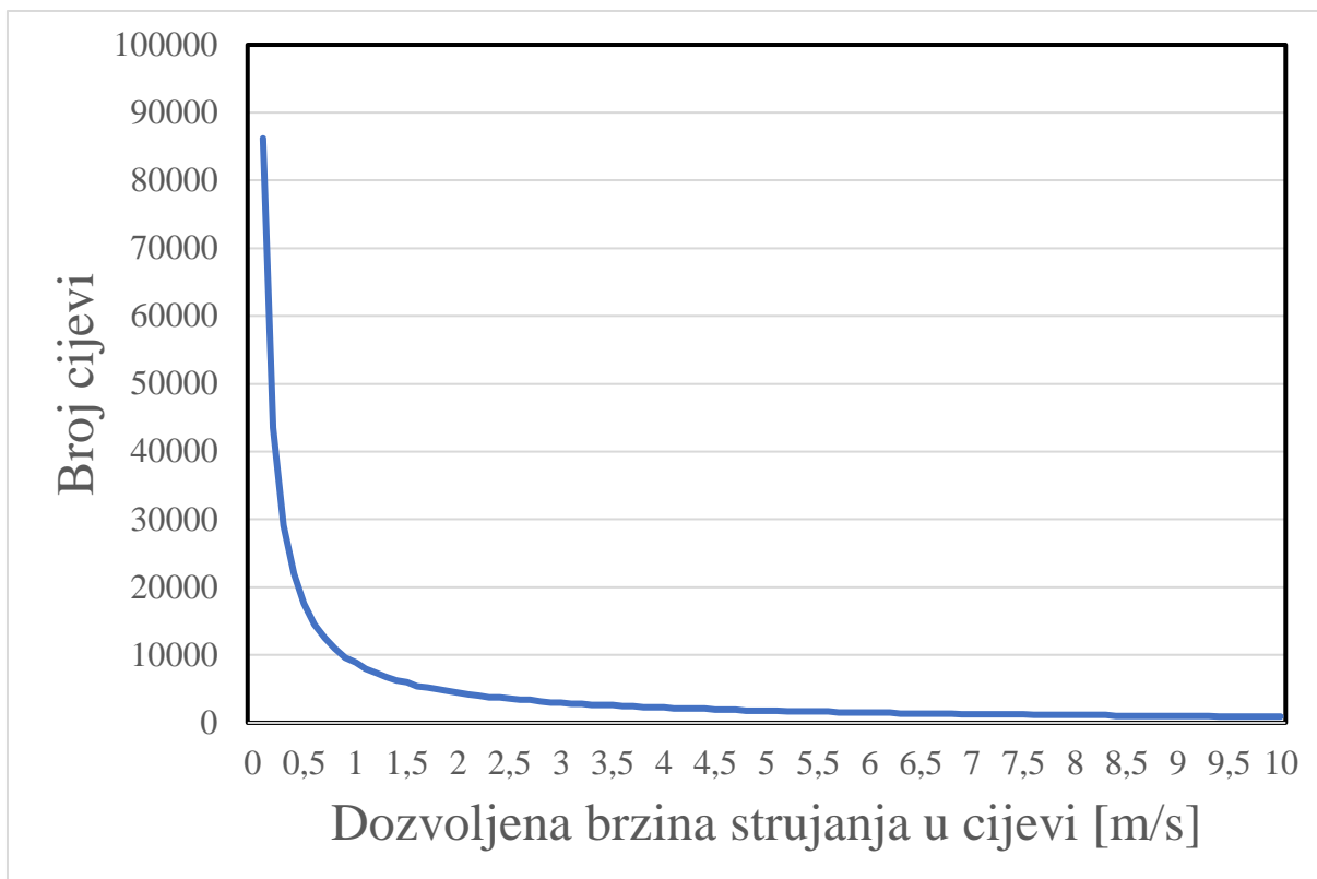
Slika 4.16. Utjecaj brzine strujanja glikol-vode na broj cijevi u izmjenjivaču
