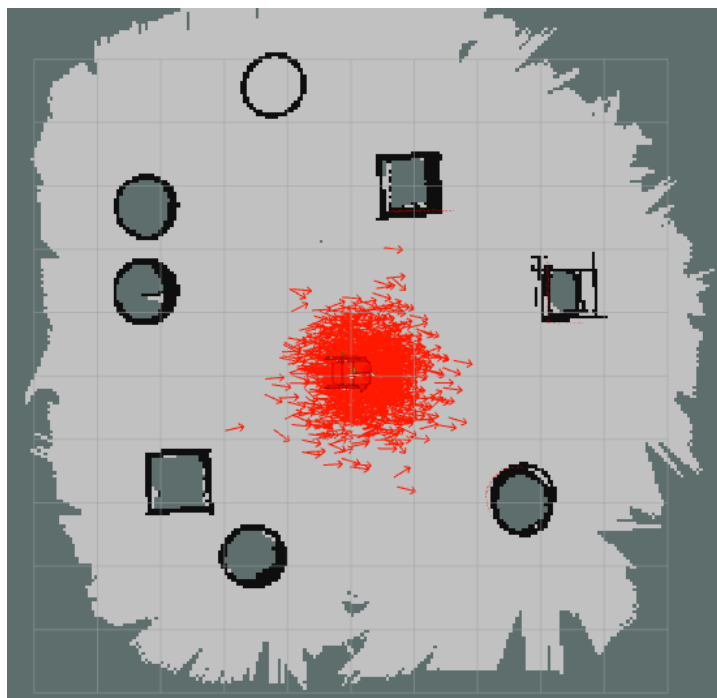
Slika 5.26 AMCL test – početna pozicija
