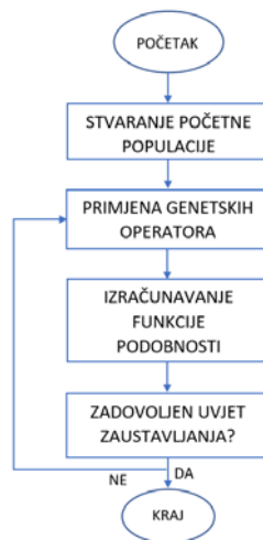
Slika 8.4. Dijagram toka genetskog algoritma
